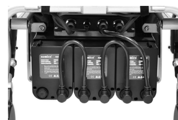
Modèle TROYA PLUS ULTRA (3 batteries, 51 km d'autonomie)
