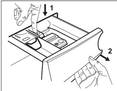
2. Presiona la palanca hacia abajo para retirar el dosificador.
