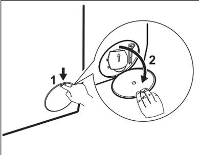
2. Coloque un recipiente debajo de la bomba de desagüe para recoger el agua que salga.
