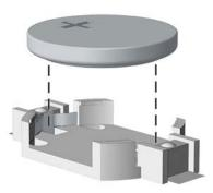
**b.** Schieben Sie die Ersatz-Batterie in Position mit dem Pluspol nach oben. Die Batterie arretiert die Batterie automatisch in der richtigen Position.
