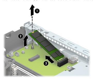
11. Um eine M.2 SSD-Karte einzubauen, schieben Sie die Stifte auf der Karte in den Systemplatinenanschluss, während Sie die Karte in einem Winkel von ca. 30° halten (1). Drücken Sie das andere Ende der Karte nach unten (2) und befestigen Sie dann die Karte mit der Schraube (3).
