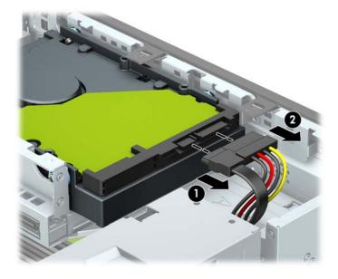
8. Ziehen Sie den Freigabehebel neben der Rückseite der Festplatte nach außen (1). Während Sie den Freigabehebel nach außen ziehen, schieben Sie die Festplatte bis zum Anschlag nach vorn und heben Sie die Festplatte dann hoch und aus dem Schacht heraus (2).
