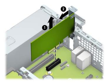
c. Wenn Sie eine PCI-Express-x16-Karte entfernen, ziehen Sie den Befestigungsarm an der Rückseite des Erweiterungssteckplatzes von der Karte weg (1), und lösen Sie die Karte durch vorsichtiges Hin- und Herbewegen aus dem Steckplatz. Ziehen Sie die Karte gerade nach oben (2) und anschließend vom Innern des Computergehäuses weg (3), um sie zu entfernen. Achten Sie darauf, dass die Karte dabei die anderen Komponenten nicht beschädigt.
