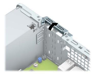
Bevor Sie eine Erweiterungskarte installieren, entfernen Sie die Steckplatzabdeckung oder die vorhandene Erweiterungskarte am Computergehäuse.
