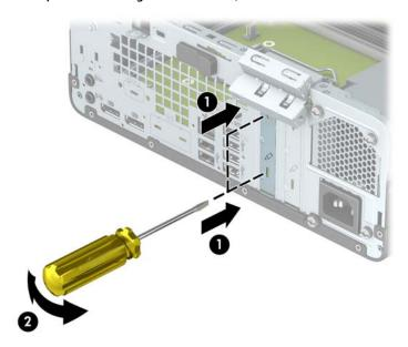
**b.** Wenn Sie eine PCI-Express-x4-Karte entfernen, halten Sie die Karte an beiden Ecken fest und bewegen Sie sie vorsichtig hin und her, bis die Anschlüsse sich vom Steckplatz lösen. Ziehen Sie die Karte gerade nach oben (1) und anschließend vom Innern des Computergehäuses weg (2), um sie zu entfernen. Achten Sie darauf, dass die Karte dabei die anderen Komponenten nicht beschädigt.
