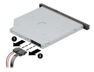
Schieben Sie den grünen Entriegelungsschieber an der rechten Rückseite des Laufwerks zur Mitte des Laufwerks (1), dann schieben Sie das Laufwerk nach vorn und heraus aus dem Schacht (2).
