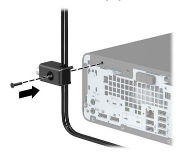
Setzen Sie das Steckerende des Sicherungskabels in die Sperre ein (1), und drücken Sie gegen den Knopf (2), um die Sperre zu aktivieren. Verwenden Sie den im Lieferumfang enthaltenen Schlüssel, um die Sperre zu lösen.
