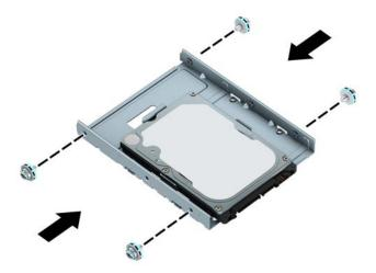
**10.** Richten Sie die Befestigungsschrauben an den Aussparungen am Laufwerkskäfig aus, drücken Sie die Festplatte nach unten in den Schacht hinein, und schieben Sie die Festplatte dann rückwärts bis zum Anschlag und bis sie einrastet.
