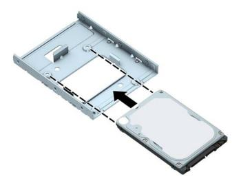
Fixieren Sie die Festplatte am Laufwerksschacht-Adapter, indem Sie vier schwarze M3-Schrauben durch die Unterseite der Adapterhalterung in die entsprechenden Bohrungen in der Festplatte hineindrehen.
