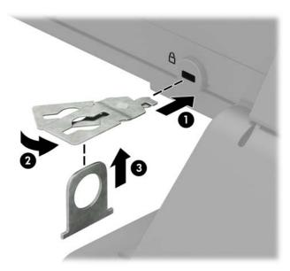
5. Schieben Sie das Sicherungskabel durch die Sicherheitsführung, die am Monitor befestigt ist.
