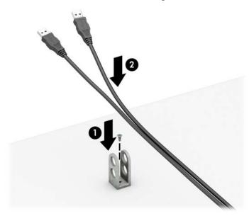
7. Schieben Sie das Sicherungskabel durch die Öffnungen in der Halterung des Zubehörkabels.
