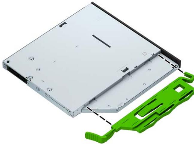
9. Schieben Sie das optische Laufwerk durch die Vorderseite des Gehäuses vollständig in den Schacht hinein, bis es einrastet (1), und verbinden Sie dann das Stromkabel (2) und das Datenkabel (3) mit der Rückseite des Laufwerks.
