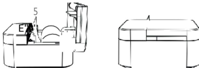
Öffnen Sie die Abdeckung in Pfeilrichtung, wie in der Abbildung gezeigt, und ziehen Sie die Papierfachabdeckung nach oben, um die Abdeckung zu öffnen. Legen Sie das Papier in der in der Abbildung gezeigten Richtung in den Drucker ein.
