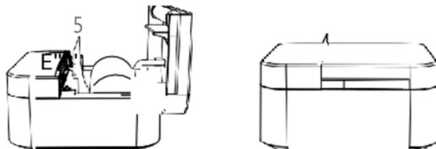
Open de deksel in de richting van de pijl zoals aangegeven in de figuur, en trek de deksel van het papiercompartiment omhoog om de deksel te openen. Leg het papier in de printer de richting zoals aangegeven in de figuur, leg het warmtegevoelige oppervlak van het papier aan dezelfde kant als de warmtegevoelige kop.
