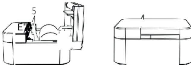
Ouvrez le couvercle dans le sens de la flèche comme indiqué sur la figure, et tirez vers le haut le couvercle du compartiment à papier pour ouvrir le couvercle. Mettez le papier dans l'imprimante dans le sens indiqué sur la figure, placez la surface thermosensible du papier du même côté que la tête thermosensible.
