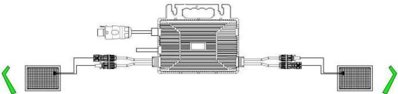
Das Verbindungskabel zwischen dem PV-Modul und dem Astro-E Microinverter muss weniger als 3 Meter lang sein.
