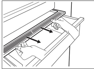
2. Wenn Sie die weiße Membran des Geräts ersetzen müssen, greifen Sie das Gerät in der Mitte und trennen Sie die Membran von der Abdeckung, indem Sie an der Abdeckung ziehen.
