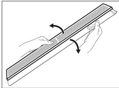
3. Monteer een nieuw membraan in de afdekking door de rand van het membraan in de afdekking te drukken.
