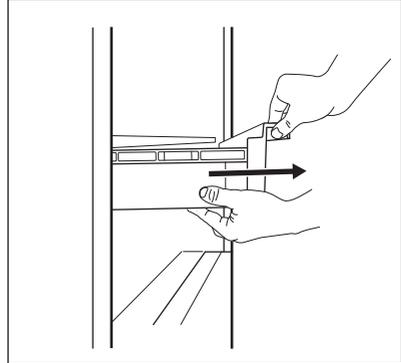
2. Heben Sie die Vorderseite der Schublade an.
