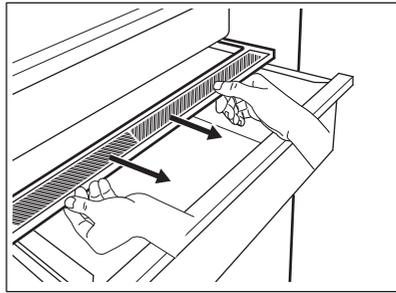
2. Als je het witte membraan van het apparaat moet vervangen, pak je het apparaat in het midden vast en scheid je het membraan van het deksel door aan het deksel te trekken.
