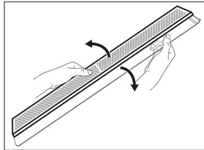
3. Setzen Sie eine neue Membran in die Abdeckung ein, indem Sie den Rand der Membran in die Abdeckung drücken.
