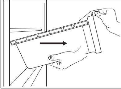
De glazen afdekking van de GreenZone lade verwijderen:
