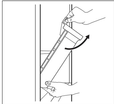
3. Til de lade op en draai hem om hem uit het apparaat te trekken.
