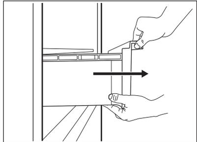
2. Heben Sie die Vorderseite der Schublade an.
