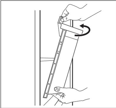
Das Regal über der Schublade kann nur zu Reinigungszwecken aus dem Gerät entfernt werden.
