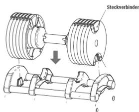
Setzen Sie die Smartlock in die Basiseinheit ein.
