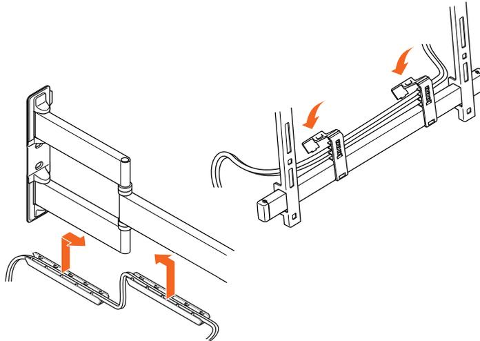
3. Entfernen Sie die Kabelarmabdeckungen vom Arm, indem Sie sie mittels Schieben abnehmen.
