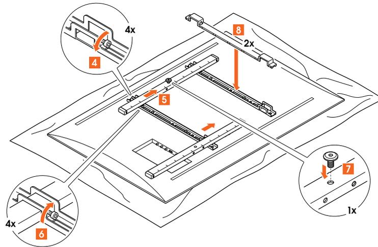
4. Lösen Sie die vormontierten Schrauben in den **vertikalen Leisten** © mit einem Inbusschlüssel.
