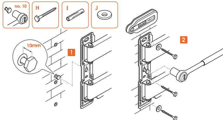
3. Befestigen Sie die **Wandhalterung** **A** mit den **Schrauben** **H**, den **Unterlegscheiben** **J** und den **Dübeln** **I** an der Wand. Mit der **Wasserwaage** **C** sorgen Sie für eine waagerechte Montage der Wandhalterung. Achten Sie darauf, dass Sie die mittlere Schraube zuerst in die Wand schrauben.
