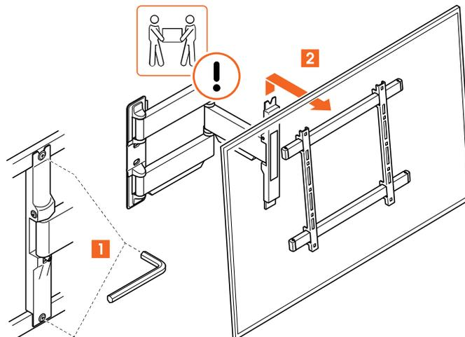
1. Entfernen Sie den unteren Adapterbolzen und lösen Sie den oberen Adapterbolzen.
