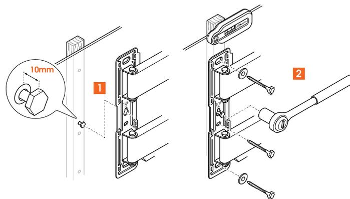
5. Befestigen Sie die **Wandhalterung** Ⓐ mit den **Schrauben** Ⓕ und den **Unterlegscheiben** Ⓖ an der Holzständerwand. Mit der **Wasserwaage** Ⓒ sorgen Sie für eine waagerechte Montage der Wandhalterung. Achten Sie darauf, dass Sie die mittlere Schraube zuerst in die Wand schrauben.
