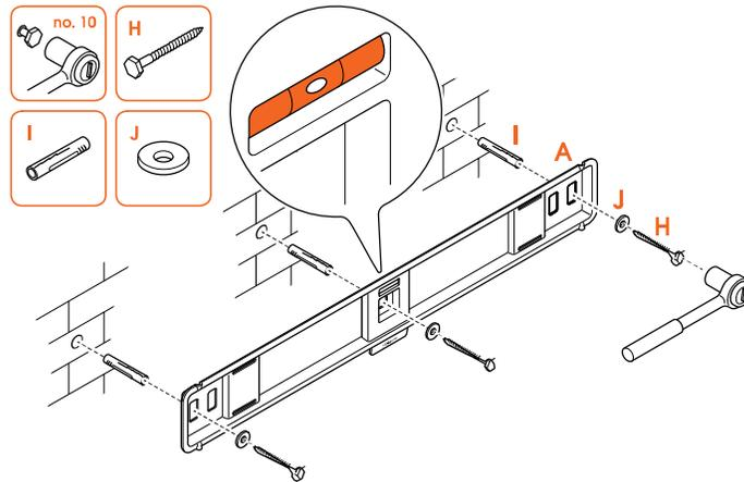
5. Befestigen Sie die **Wandhalterung** (A) mit den **Schrauben** (H), den **Unterlegscheiben** (J) und den **Dübeln** (I) an der Wand. Mit der **Wasserwaage** (C) sorgen Sie für eine waagerechte Montage der Wandhalterung. Achten Sie darauf, dass Sie die mittlere Schraube zuerst in die Wand schrauben.
