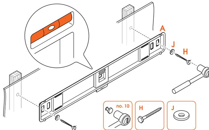
5. Befestigen Sie die **Wandhalterung** **A** mit den **Schrauben** **H** und den **Unterlegscheiben** **J** an der Holzständerwand. Mit der **Wasserwaage** **C** sorgen Sie für eine waagerechte Montage der Wandhalterung. Achten Sie darauf, dass Sie die mittlere Schraube zuerst in die Wand schrauben.
