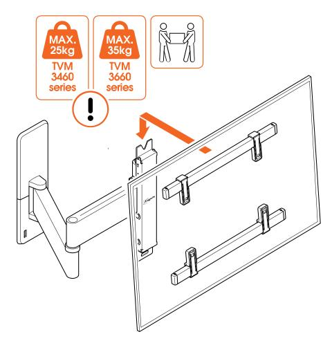
1. Solleva con cautela la TV e fissala al **supporto a muro** ②. Posiziona la **vite di interfaccia** superiore ② nella tacca superiore del supporto a muro.
