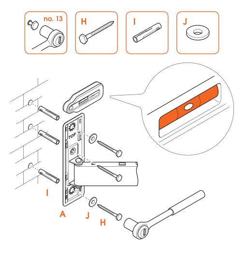
3. Fissa il **supporto a muro** ⓐ alla parete con le **viti** ⊕, le **rondelle** ⊕ e **i tasselli** ⊕. Utilizza la **livella** ⊚ per livellare il supporto a muro.
