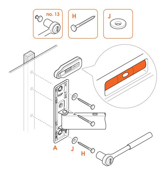
5. Fissa il **supporto a muro** (a) ai montanti in legno con le **viti** (b) e **le rondelle** (c). Utilizza la **livella** (c) per livellare il supporto a muro.
