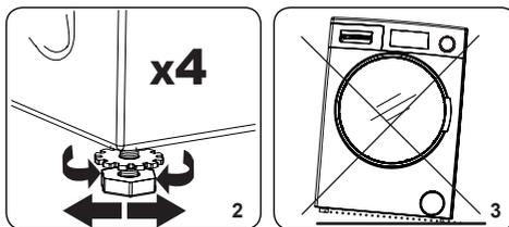
2. Drehen Sie die FüÙe zum Anheben der Maschine im Uhrzeigersinn. Drehen Sie die FüÙe zum Absenken der Maschine gegen den Uhrzeigersinn.
