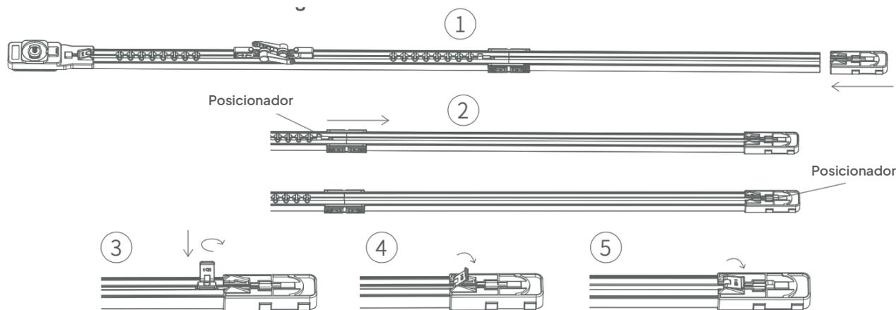
(e) Desbloquee la corredera maestra (importante: no desbloquee la corredera secundaria, esta última tiene una pegatina de advertencia para evitar errores). Tire de las dos correderas hacia ambos extremos del riel y vuelva a bloquear la corredera maestra.
