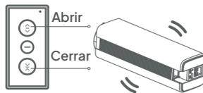
Pulse abrir y cerrar del mando a distancia. A al mismo tiempo, hasta que el motor vibre. La luz amarilla del motor parpadeará.
