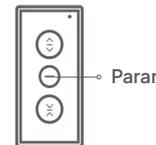
Pulse el botón de parada hasta que el motor vibre. Tras soltar el botón, el motor volverá a vibrar dos veces. El motor se ha restablecido.
