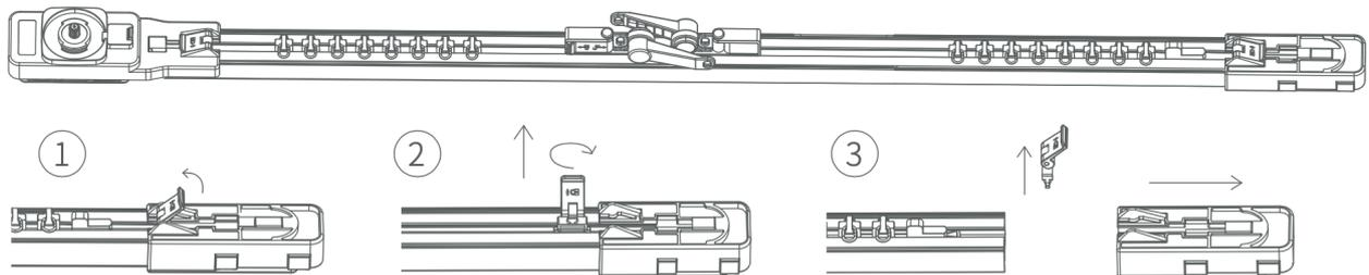
(b) Deslice los empalmes del riel en el perfil y fíjelos cuando estén colocados como se muestra en la siguiente imagen:
