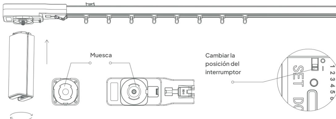
Para desmontar el motor, tire de la pequeña hebilla de la polea principal (mostrada en la imagen) y gire el motor 90° en el sentido de las agujas del reloj.
