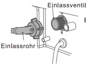
1. Schließen Sie das Einlassrohr an das Einlassventil an.
