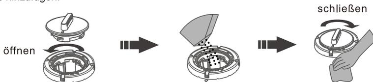
1. Drehen Sie den Wasserenthärter-Deckel gegen den Uhrzeigersinn und nehmen Sie ihn ab.
