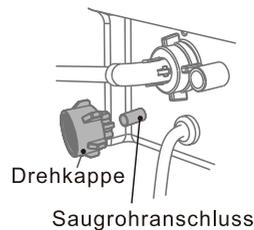
3. Wenn das Saugrohr funktioniert, setzen Sie bitte die Drehkappe in den Saugrohranschluss, da sonst das Wasser aus dem Saugrohranschluss sickert.
