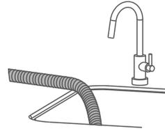
1. Ablass und Ablassanschluss anschließen
