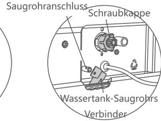
**A** Stecken Sie das Saugrohr des Wassertanks in den Wassereinlass des Wassertanks gemäß der in der Abbildung gezeigten Richtung.
