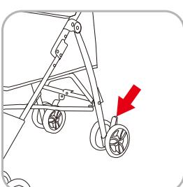
A. Freinage : Appuyer sur les leviers de frein de la roue arrière des deux côtés.
