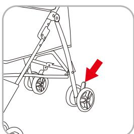
A. Frenata: Premere le leve del freno della ruota posteriore su entrambi i lati.
