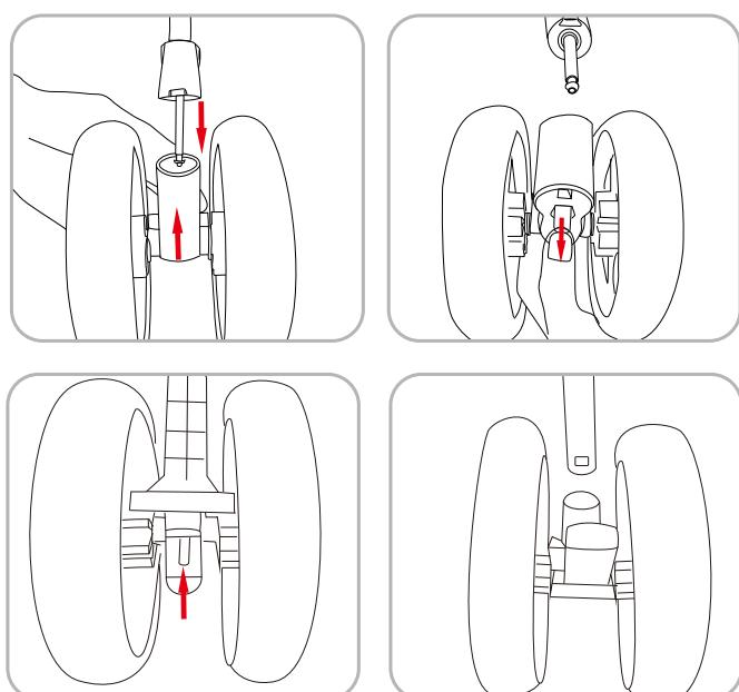
**1. Instalar e desmontar as rodas dianteiras:** Introduzir o conjunto da roda dianteira no assento da roda dianteira; está instalado quando se ouve um “clique”. Pressionar a fivela do assento da roda dianteira com a mão e puxá-la para baixo; em seguida, o conjunto da roda dianteira é retirado.
