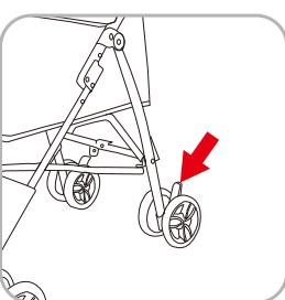
A. Bremsen: Drücken Sie die Hinterradbremshandgriffe auf beiden Seiten herunter.
