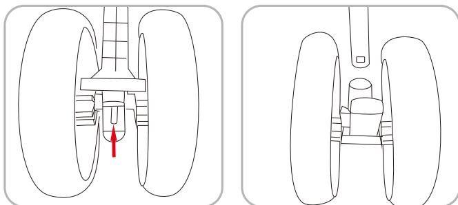
2. montieren und demontieren Sie die Hinterräder: Stecken Sie den Hinterradsitz in den Hinterradsitz, er ist montiert, wenn der Widerhaken am Hinterradsitz herausspringt. halten Sie den Widerhaken am Hinterradsitz und ziehen Sie ihn heraus, der Hinterradsitz kann entfernt werden.
