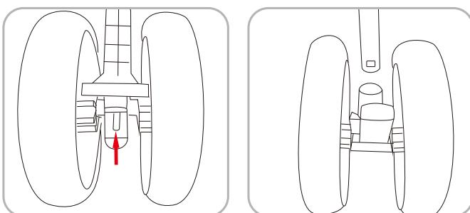
2. Installare e smontare le ruote posteriori: inserire il set di ruote posteriori nella sede della ruota posteriore, è installato quando l'asta sulla sede della ruota posteriore fuoriesce. Tenere l'asta sulla sede della ruota posteriore e tirarla fuori, il set di ruote posteriori può essere rimosso.
