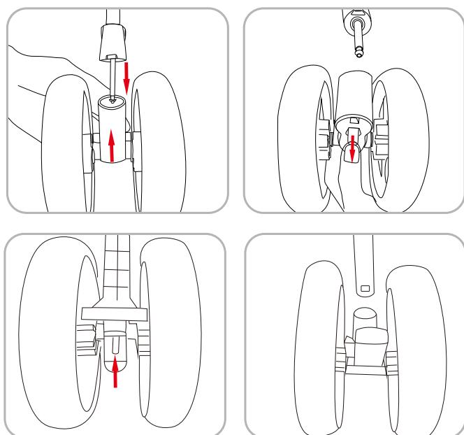
1. installer et démonter les roues avant : Insérer le train de roues avant dans le siège de la roue avant, il est installé lorsqu'on entend le « clic ». Appuyer sur la boucle du siège de la roue avant avec la main et la tirer vers le bas, puis le train de roues avant est enlevé.
