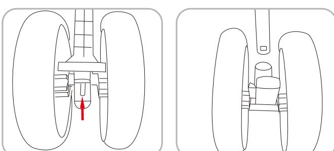
**2. Instalación y desmontaje de las ruedas traseras :** Inserte el juego de ruedas traseras en el asiento de las ruedas traseras, estará instalado cuando la lengüeta del asiento de las ruedas traseras salte hacia fuera.
