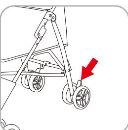
**A. Travagem:** Pressionar para baixo as alavancas dos travões da roda traseira de ambos os lados
