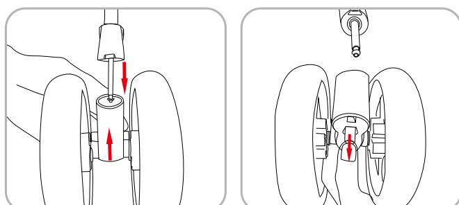
**1. Instale y desmonte las ruedas delanteras:** Inserte el juego de ruedas delanteras en el asiento de las ruedas delanteras, estará instalado cuando oiga «Click». Presione la hebilla del asiento de las ruedas delanteras con la mano y tire de ella hacia abajo, entonces se retira el juego de ruedas delanteras.
