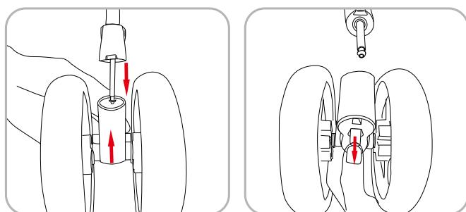
1. Installare e smontare le ruote anteriori: Inserire il set di ruote anteriori nella sede delle ruote anteriori, è installato quando si sente "Click". Premere con la mano la fibbia sulla sede delle ruote anteriori e tirarla verso il basso, quindi rimuovere il set di ruote anteriori.
