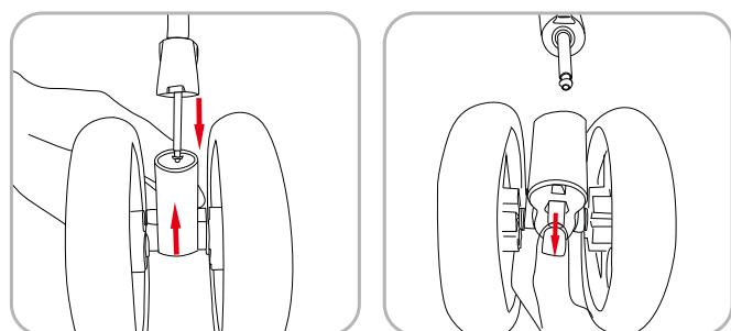
1. montieren und demontieren Sie die Vorderräder: Setzen Sie den Vorderradsitz in den Vorderradsitz ein, er ist eingebaut, wenn Sie „Klick“ hören. Drücken Sie die Schnalle am Vorderradsitz mit der Hand und ziehen Sie sie nach unten, dann wird der Vorderradsitz entfernt.
