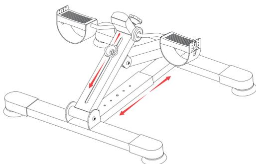
2. Utilizzare la manopola di regolazione della tensione per aumentare/diminuire la resistenza: inserirla nella parte superiore dell'unità e allentare/stringere come desiderato fino a raggiungere un livello confortevole.
