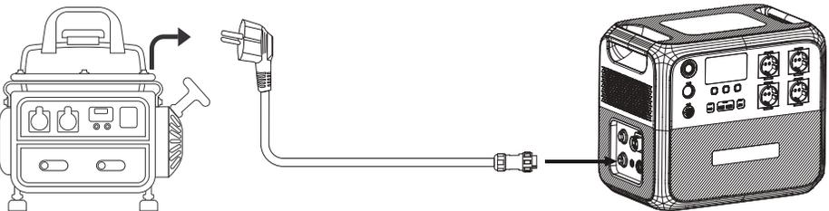
**Hinweis:** Vergewissern Sie sich, dass Ihr Generator den AC-Ausgang mit der Ladespannung, der Frequenz und der Spannung des Netzanpassungsmodus liefert, die den Spezifikationen der AC200P L entsprechen.
