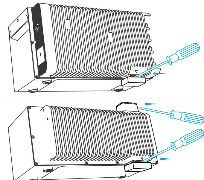
💡 Hinweis: Wenn Sie den unteren Akkupack oder nur eine Solarbank installieren, entfernen Sie bitte nicht den unteren Gummistopfen, um Wasserschäden am Gerät zu vermeiden.
