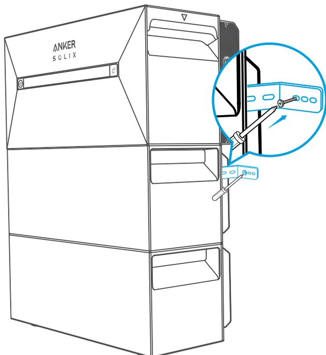
7. Verwenden Sie einen Kreuzschlitzschraubendreher, um die Kombi-Kreuzschlitzschrauben M5×10 an der L-förmigen Wandhalterung zu befestigen. Befestigen Sie dann die Verriegelungshalterung mit den Kombi-Kreuzschlitzschrauben M5×10 am Erweiterungsakku, um die Installation abzuschließen.
