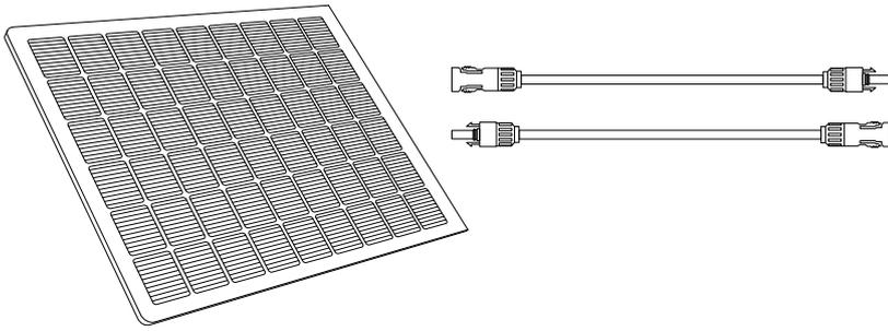
3. Verbinden Sie jeden Satz PV-Module mit jedem Satz PV-Eingangsanschlüssen in der Solarbank mit dem mitgelieferten Anker SOLIX Solarpanel-Verlängerungskabel (3m).
