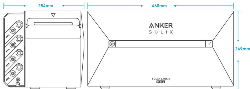
Abbildung: Anker SOLIX BP1600 Erweiterungsakku
