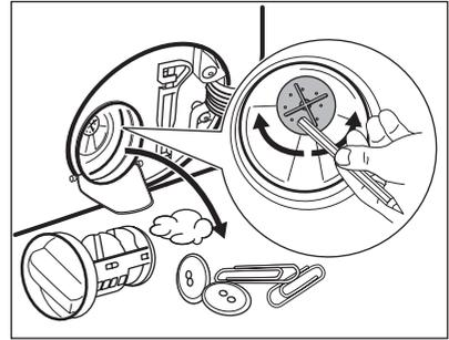
10. Reinigen Sie das Sieb unter fließendem Wasser.
