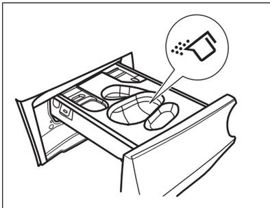
b) Gießen Sie das **flüssige Reinigungsmittel** in das gleiche Fach nach dem Einsetzen der entsprechenden
