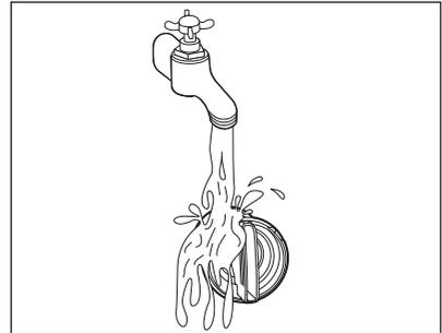
11. Setzen Sie das Sieb wieder in die dafür vorgesehenen Führungen ein und drehen Sie es im Uhrzeigersinn. Achten Sie darauf, dass Sie das Sieb richtig fest anziehen, um Wasserlecks zu vermeiden.
