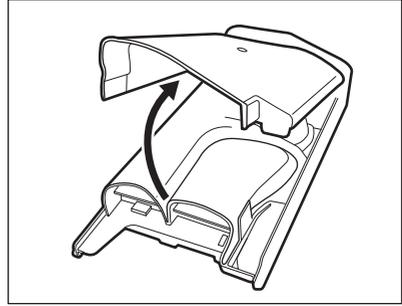
7. Stellen Sie sicher, dass alle Waschmittelmrückstände aus dem Einspülkasten entfernt wurden. Verwenden Sie nur weiche, feuchte Tücher.
