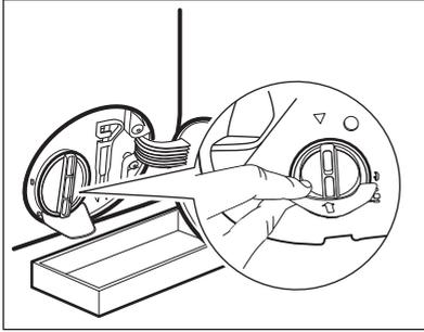
4. Drehen Sie das Sieb um 180 Grad gegen den Uhrzeigersinn, um es zu öffnen und entfernen Sie es nicht. Lassen Sie das Wasser ablaufen.
