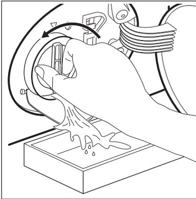
5. Wenn der Behälter voll ist, drehen Sie das Sieb zurück und leeren Sie den Behälter.
