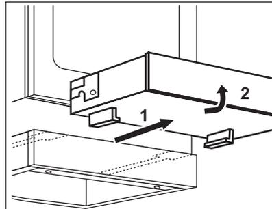
2. Heben Sie die Schublade in einem leichten Winkel an und entfernen Sie sie von den Schubladenschienen.
