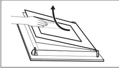
4. Reinigen Sie die Glasscheiben. Zum Anbringen der Glasscheiben, führen Sie die Schritte zum Ausbau in umgekehrter Reihenfolge aus.
