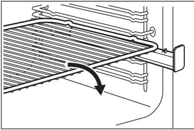
Setzen Sie den Kombirost so auf die Teleskopschienen, dass die FüÙe nach unten zeigen.
