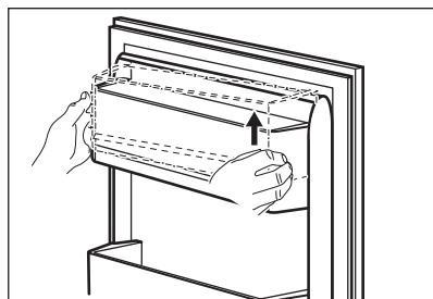
3. Heben Sie die linke Seite der Ablage an und entfernen Sie sie. Einsetzen der Ablage:
