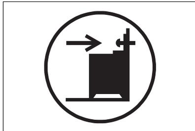
1. Installiere den Kippschutz 317 - 322 mm unterhalb der Oberseite des Geräts und 80 - 85 mm von der Seite des Geräts im kreisförmigen Loch in einer Halterung. Schraube ihn in das feste Material oder verwende eine geeignete Verstärkung (Wand).
