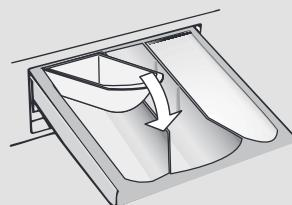
EINIGE MODELLE sind mit einer automatischen Dosierung ausgestattet, die Waschmittel und Weichspüler exakt dosiert. In diesem Fall ziehen Sie den spezifischen Abschnitt im Kapitel STEUERUNG UND PROGRAMME für weiterführende Informationen hinzu.
