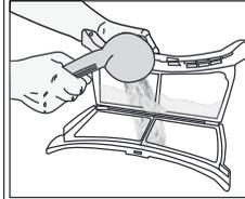
Im Laufe der Zeit können sich die Poren des Filters zusetzen. Zum Entfernen von Rückständen waschen Sie den Fusselfilter mit warmem Wasser aus. Lassen Sie den Fusselfilter vollständig trocknen, bevor Sie ihn wieder einsetzen.
