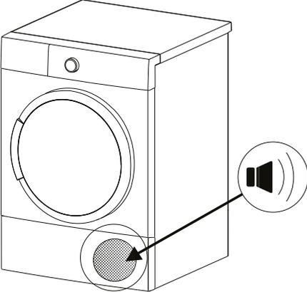
A line drawing of a front-loading washing machine. A circular area at the bottom left is shaded with a stippled pattern and circled, with an arrow pointing to a speaker icon. The speaker icon is a black trapezoid with two curved lines to its right, indicating sound. | <p><b>Kompressorgeräusche</b></p> <p>Es ist normal, dass der Kompressor zu gewissen Zeiten ein metallisches Geräusch abgibt, während die Maschine läuft.</p>                                                          |
