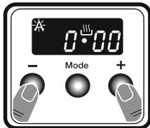
1. Die Tasten „+“ und „-“ gleichzeitig drücken. Das Symbol
