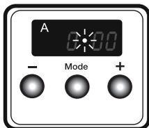
3. Nach einigen Sekunden hört der Punkt auf zu blinken und leuchtet dauerhaft.
