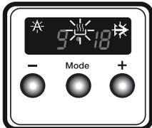
4. Daraufhin wird wieder die aktuelle Uhrzeit auf der Anzeige angezeigt, und die Symbole „A“,  $\rightarrow$  und  $\text{☀}$  leuchten dauerhaft.
