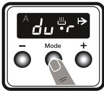
2. Die Taste „Mode“ so lange drücken, bis der Wert „dur“ und das Symbol  $\rightarrow$  auf der Anzeige angezeigt werden. Daraufhin blinkt das Symbol „A“.
