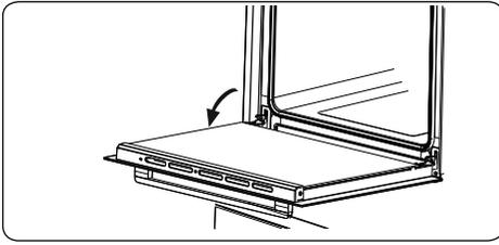
2. Den Sicherheitsbügel **a** mit einem Schraubendreher bis zum Anschlag öffnen.
