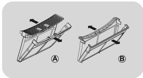
3. Entfernen Sie Fusseln aus beiden Filtern vorsichtig mit den Fingerspitzen oder mit einer weichen Bürste, einem Tuch oder unter fließendem Wasser.
