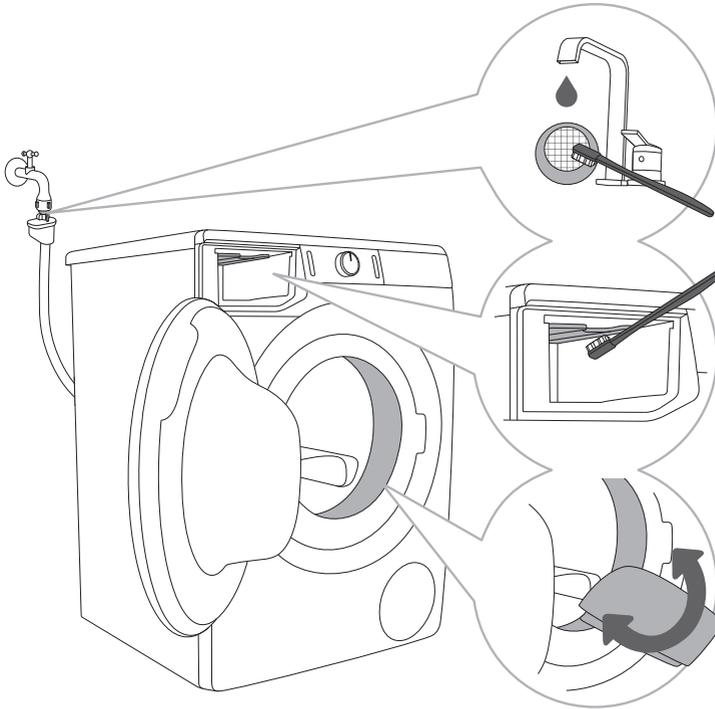
**1** Reinigen Sie den Filter im Zulaufschlauch unter fließendem Wasser.
