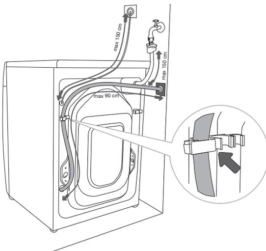
⚠ Bei Nichtbeachtung der Befestigung des Ablaufschlauchs kann kein störungsfreier Betrieb der Waschmaschine gewährleistet werden.
