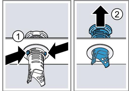
5. Unter fließendem Wasser die Siebelemente reinigen.
