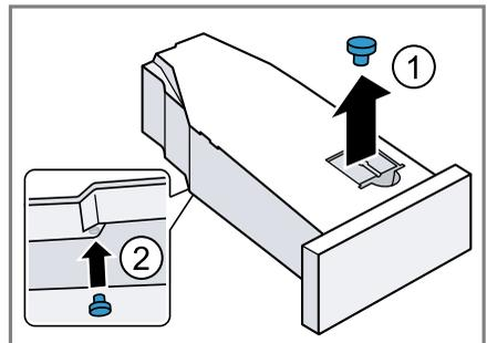
2. Den Filter im Kondenswasserbehälter reinigen.
