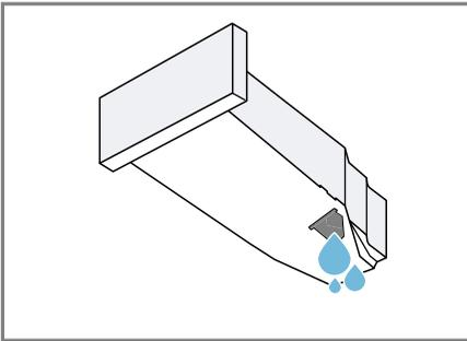
Prüfen Sie regelmäßig den Filter des Kondenswasserbehälters und reinigen Sie einen verunreinigten Filter. → Seite 41
