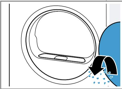
3. Das zweiteilige Flusensieb entfernen.
