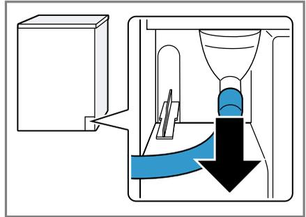
Der Kondenswasserschlauch ist werkseitig am Stutzen angeschlossen.
