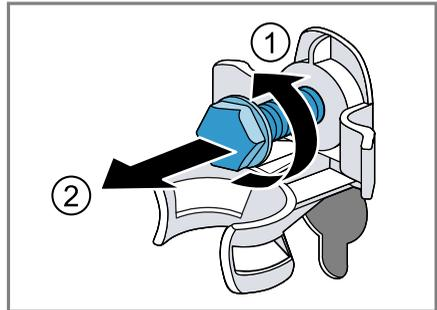
3. Die Netzanschlussleitung von der Halterung entfernen.
