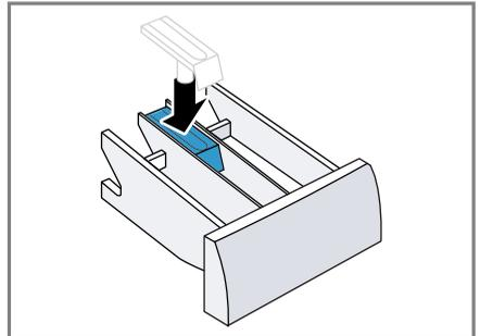
6. Die Öffnung für die Waschmittelschublade reinigen.
