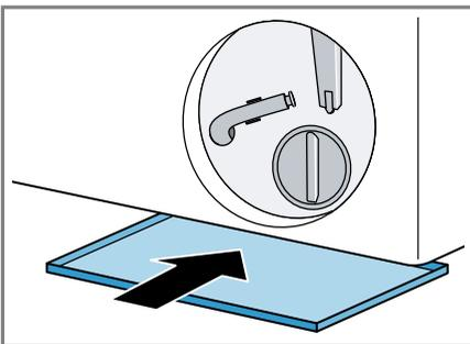
6. Den Entleerungsschlauch aus der Halterung nehmen.
