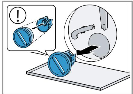
Der Pumpendeckel besteht aus zwei Bauteilen die zur Reinigung auseinanderggebaut werden können.
