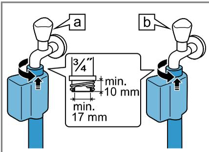
Wenn kein Wasserhahn für Warmwasser vorhanden ist, nur den Wasserzulaufschlauch für Kaltwasser anschließen. Den Warmwasseranschluss am Gerät abdecken, um ihn vor Verschmutzung zu schützen.
