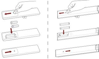
1. Öffnen Sie das Batteriefach der Fernbedienung.
