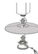
4. Führen Sie das Netzkabel durch den Ausschnitt an der Basis.
