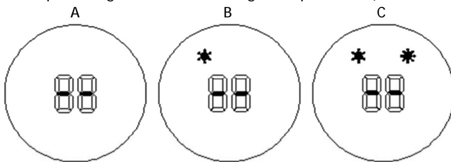
3. Temporizador de desligamento. Pressione o botão para definir o temporizador (1-12 horas) durante o status de trabalho. Pressionar o botão uma vez aumenta uma hora para o timer. Depois de definir a hora, o visor mostrará o tempo de ajuste atual por 5 segundos e, em seguida, voltará à exibição anterior, enquanto a luz estiver acesa. Abaixo foto é um exemplo de configuração 8h.
