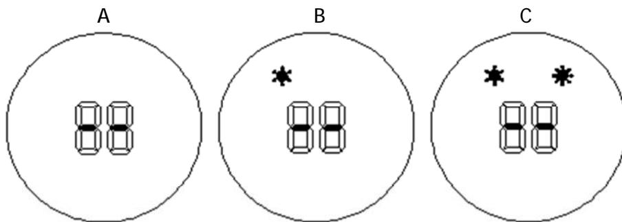
3. Temporizador de apagado. Pulse el botón para ajustar el temporizador (1-12 horas) mientras esté en funcionamiento. Pulse el botón 1 vez e incrementará 1 hora de temporizador. Después de ajustar el temporizador, la pantalla mostrará el tiempo seleccionado durante 5 segundos, después volverá a mostrar la pantalla que había anteriormente, mientras tanto el logo se encenderá en la pantalla. Abajo se muestra ejemplo de display con 8H de temporizador:
