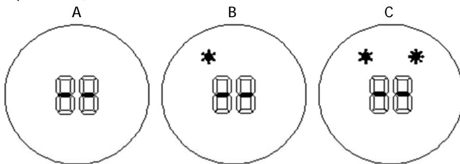
3. Minuterie d'extinction. Appuyez sur le bouton pour régler la minuterie (1-12 heures) pendant l'état de fonctionnement. Appuyer une fois sur le bouton augmente d'une heure pour la minuterie. Après le réglage du temps, l'écran affichera le temps de réglage actuel pendant 5 secondes, puis reprendra l'affichage précédent, pendant ce temps la lumière sera allumée. Ci-dessous la photo est un exemple de réglage 8h.
