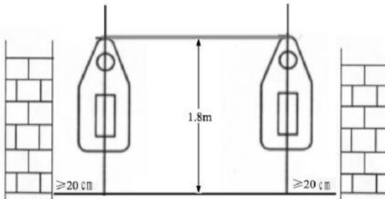
Faça dois furos na parede e tenha uma distância de 1,8 m do solo. O diâmetro do furo continha apenas o tubo de plástico inflado. Introduza o tubo de plástico inflado nos orifícios e aperte os parafusos fornecidos, deixando-os ficarem um pouco. Pendure o aparelho nos parafusos.
