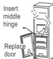
8. Coloque la puerta del refrigerador en la bisagra central, asegurándose de que el pasador de la bisagra esté insertado en el orificio en la parte inferior de la puerta del refrigerador. Luego coloque la bisagra superior, apunte a la puerta y atornille el perno, cubra la cubierta de la bisagra izquierda y luego atornille el perno.
