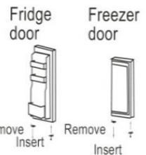
7. Coloque la puerta del congelador en la bisagra inferior, asegurándose de que el pasador de la bisagra esté insertado en el orificio en la parte inferior de la puerta del refrigerador. Vuelva a colocar la bisagra central en el gabinete, asegurándose de que esté en el lado opuesto de su posición original.
