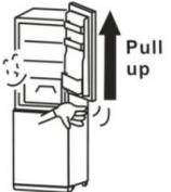
3. Con un destornillador, desmonte la bisagra central. Levante la puerta hacia arriba para desengancharla de la bisagra inferior. Coloque la puerta a un lado y colóquela suavemente sobre una superficie acolchada.
