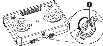
**6** Limpie la bandeja del dispensador automático y las válvulas de retención con agua caliente.
