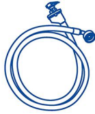
Tuyau d'arrivée d'eau (1)
