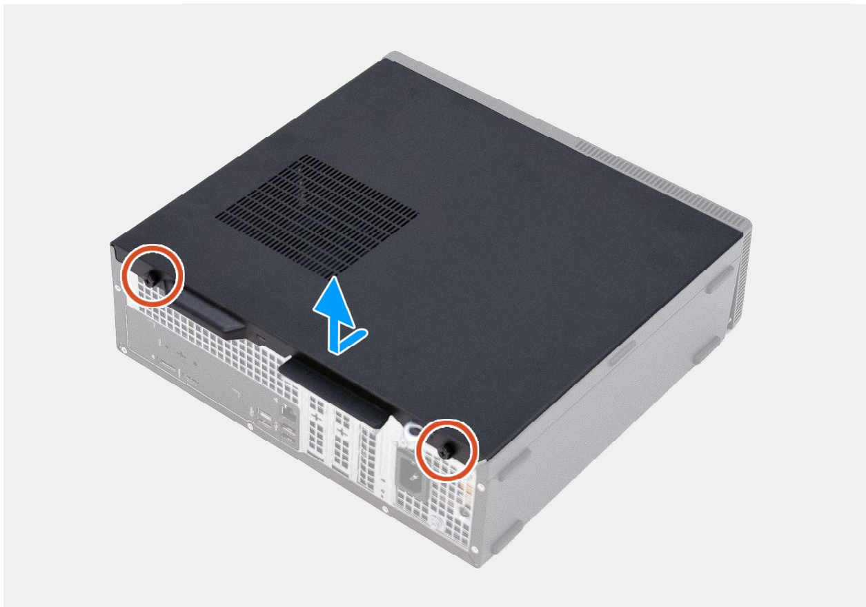
Abbildung 10. Entfernen der linken Abdeckung
