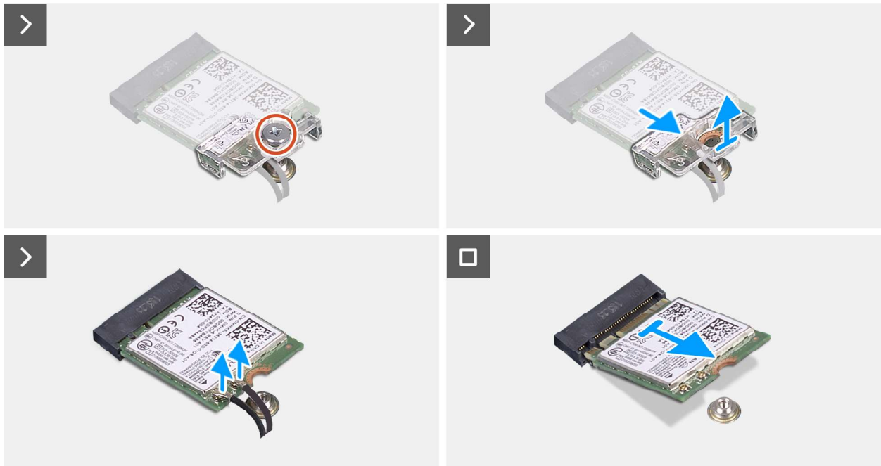
Abbildung 27. Entfernen der Wireless-Karte
