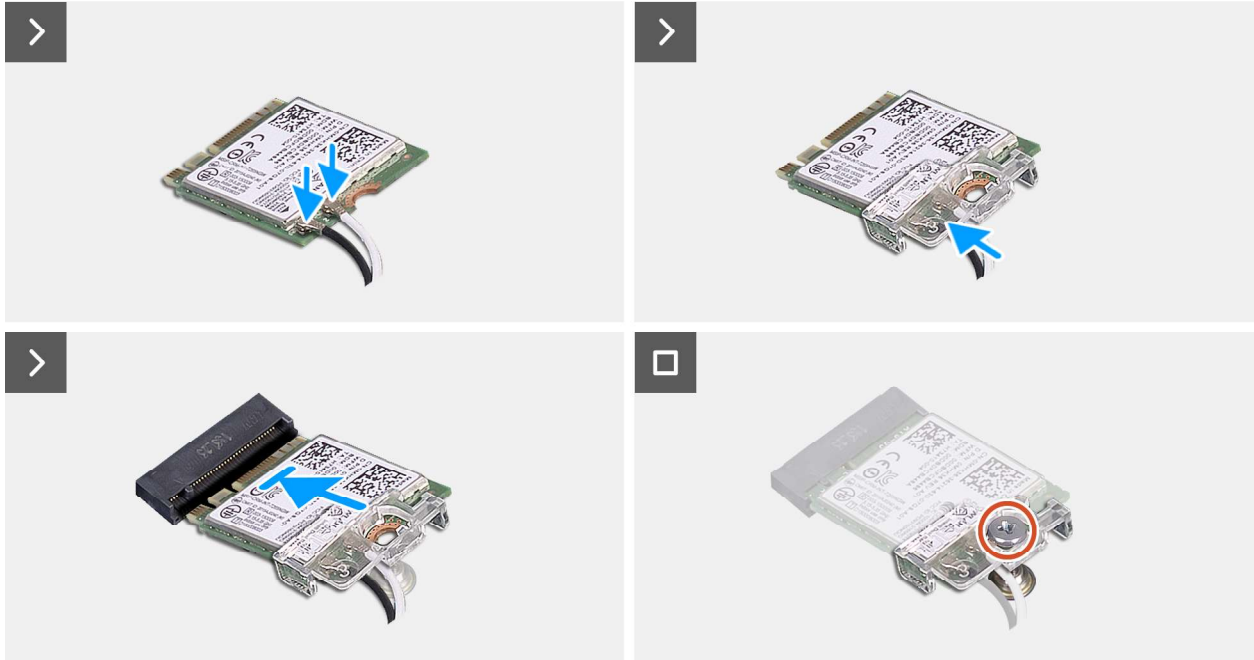
Abbildung 28. Installieren der Wireless-Karte
