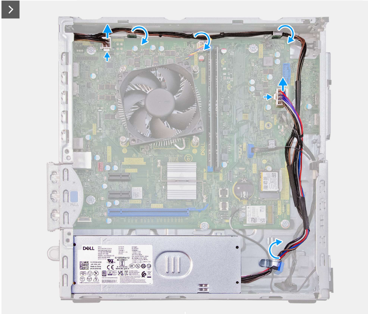
Abbildung 33. Entfernen der Stromversorgungseinheit
