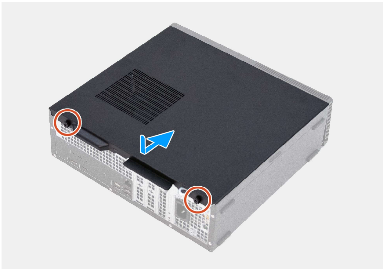
Abbildung 11. Installieren der linken Abdeckung
