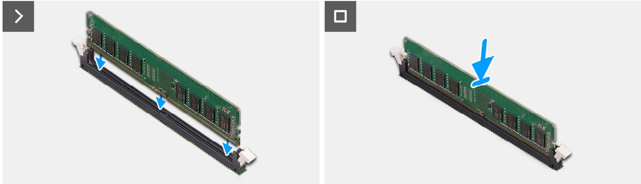
Abbildung 24. Einsetzen des Speichermoduls
