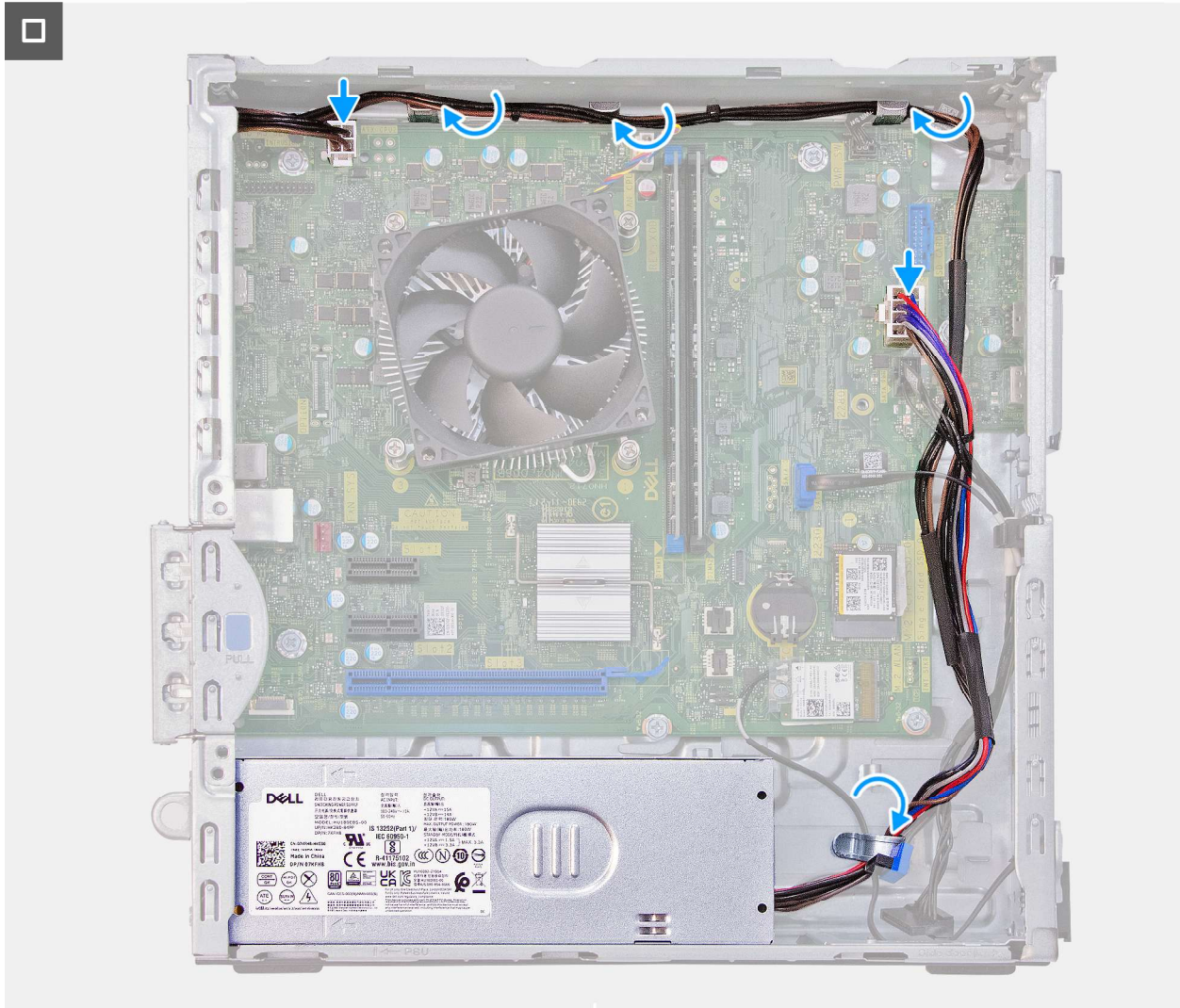
Abbildung 36. Installieren der Stromversorgungseinheit
