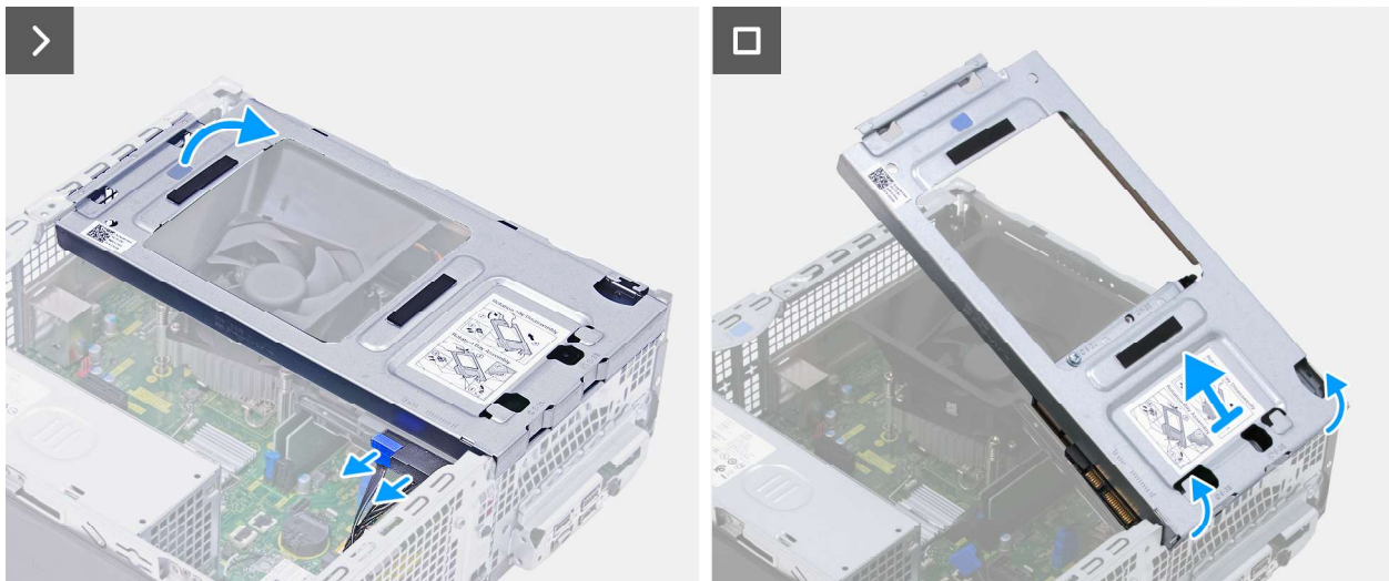
Abbildung 18. Entfernen des Laufwerksschachts
