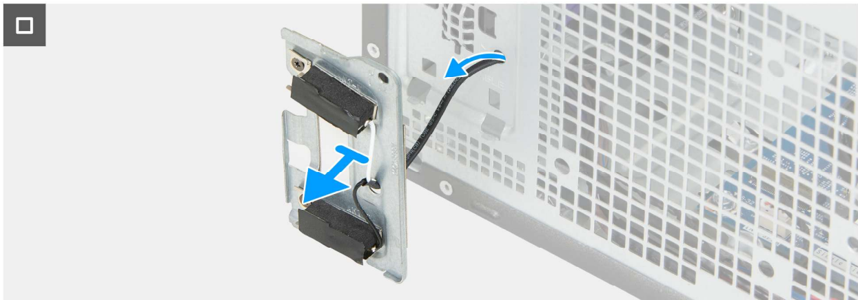
Abbildung 31. Entfernen des Antennenmoduls
