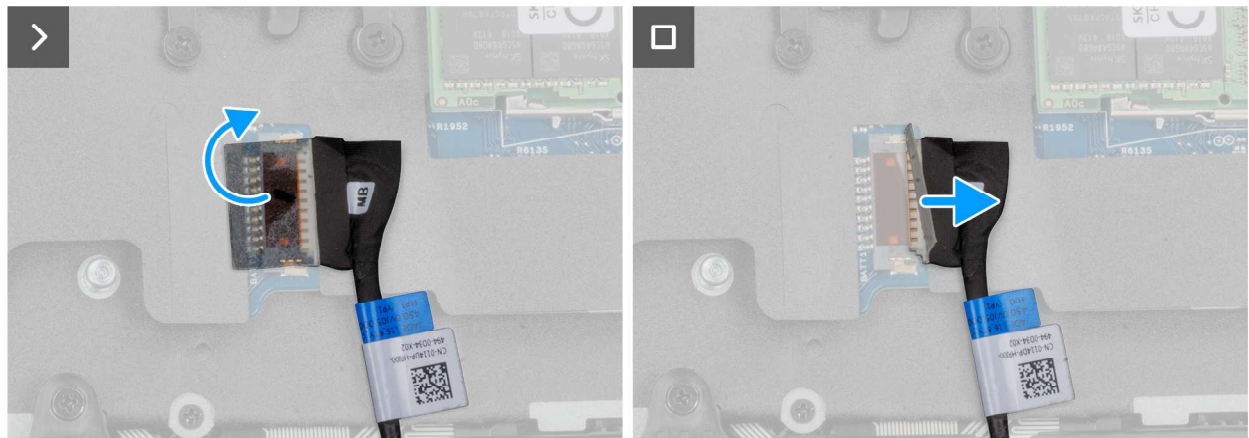
Abbildung 13. Trennen des Akkukabels
