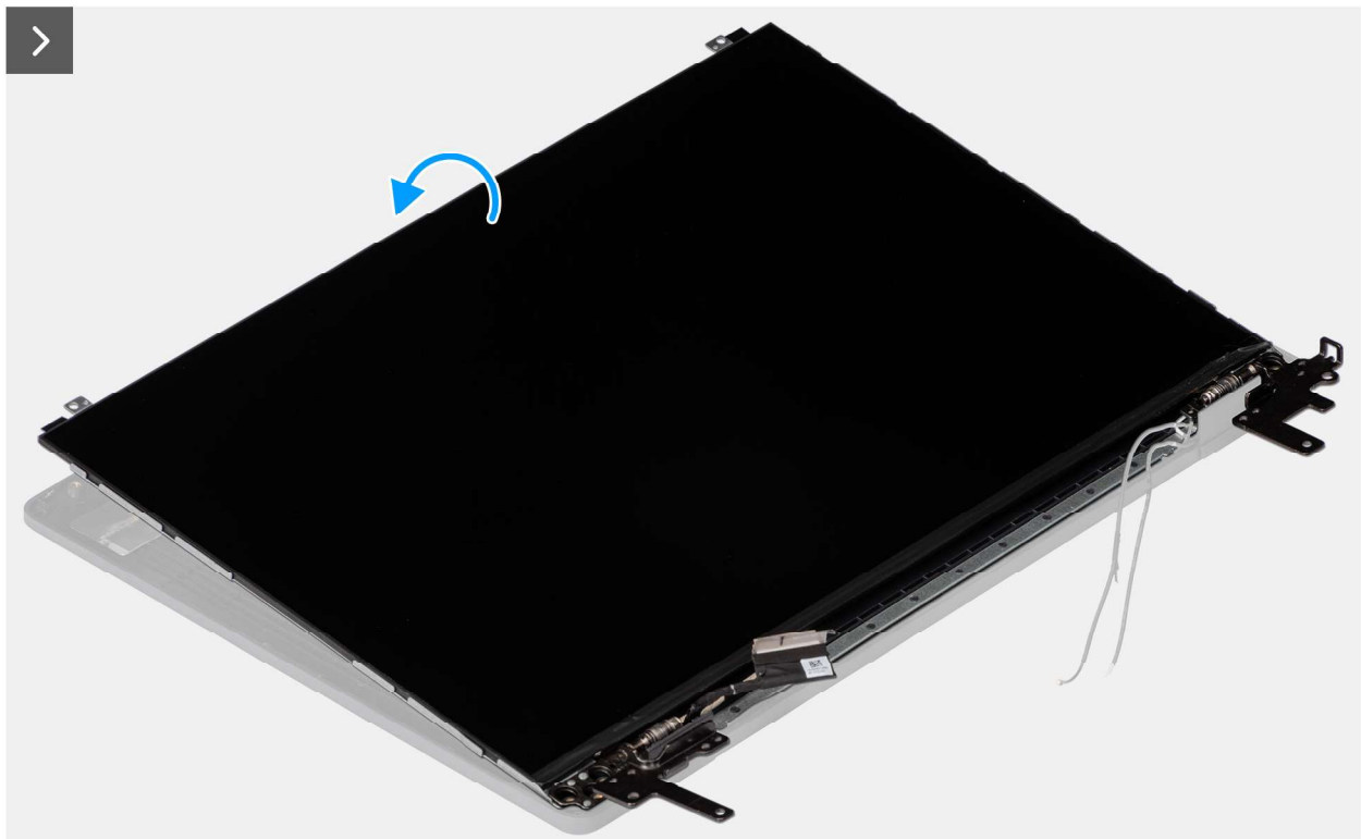
Abbildung 80. Installieren der Bildschirmbaugruppe
