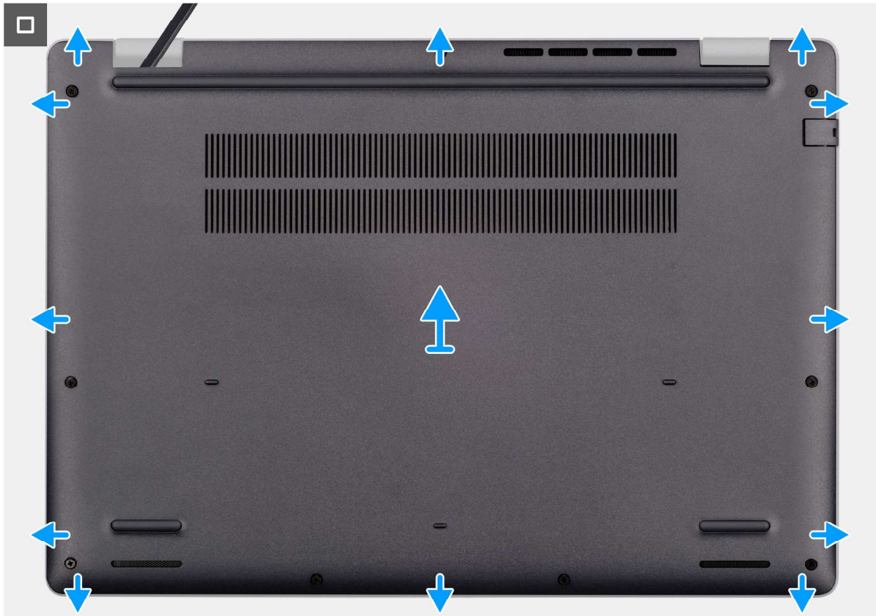
Abbildung 12. Entfernen der Bodenabdeckung
