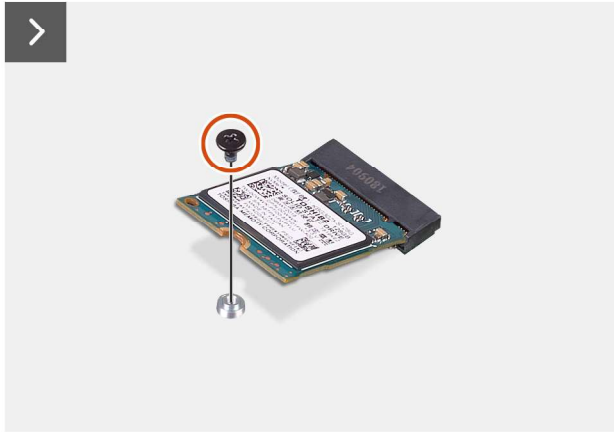
Abbildung 23. Entfernen des SSD
