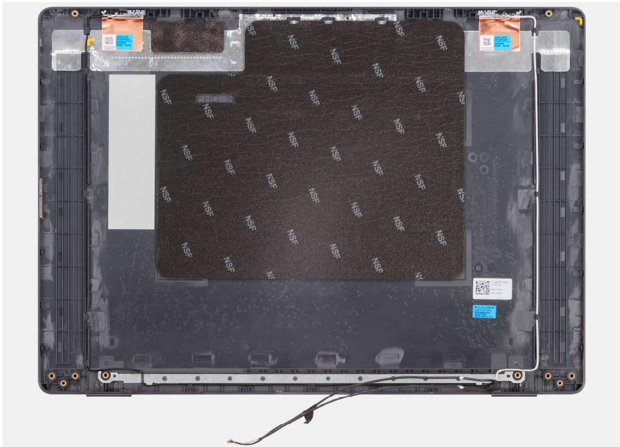
Abbildung 87. Einbauen der Baugruppe der hinteren Bildschirmabdeckung
