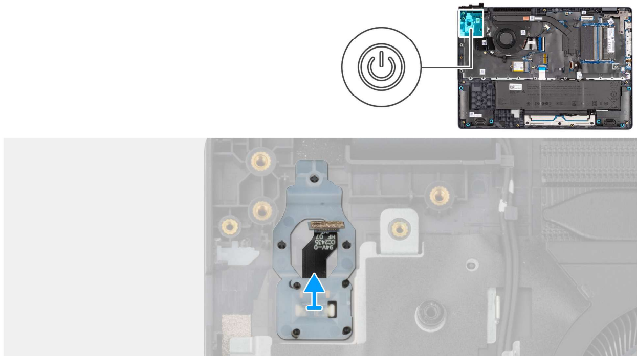
Abbildung 40. Entfernen des Netzschalters mit Fingerabdruck-Lesegerät
