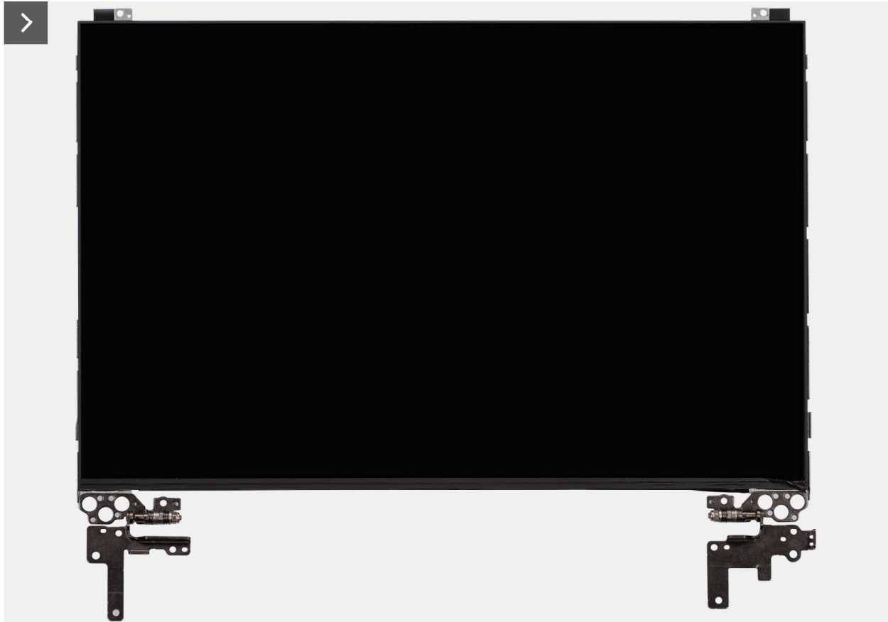
Abbildung 78. Installieren der Bildschirmbaugruppe
