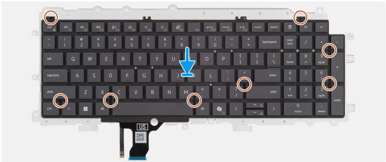
Abbildung 59. Installieren der Tastaturstützplatte
