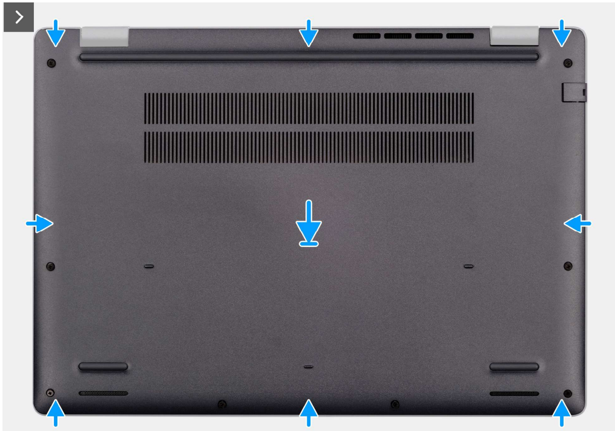
Abbildung 15. Anbringen der Bodenabdeckung
