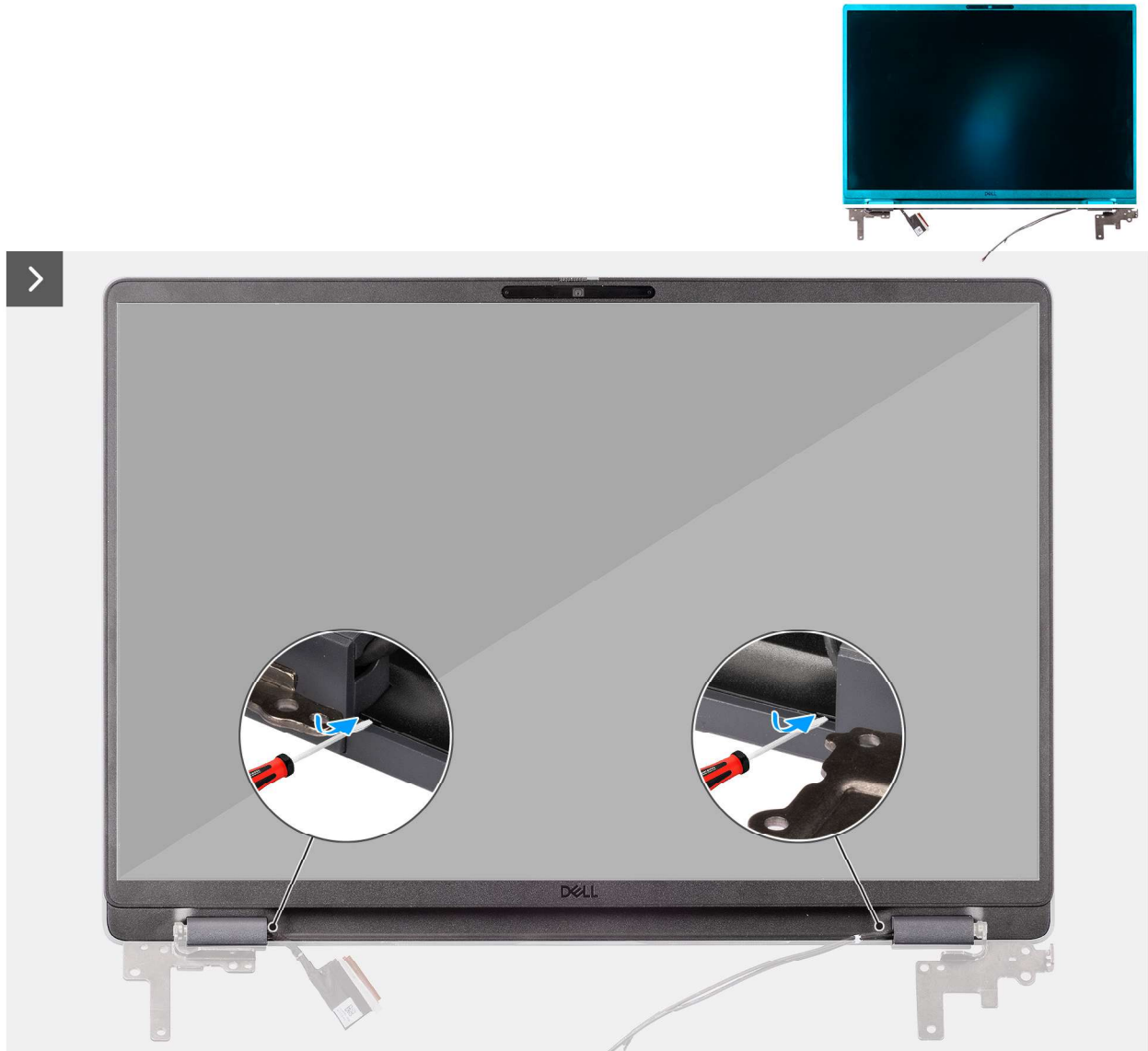
Abbildung 67. Entfernen der Bildschirmblende
