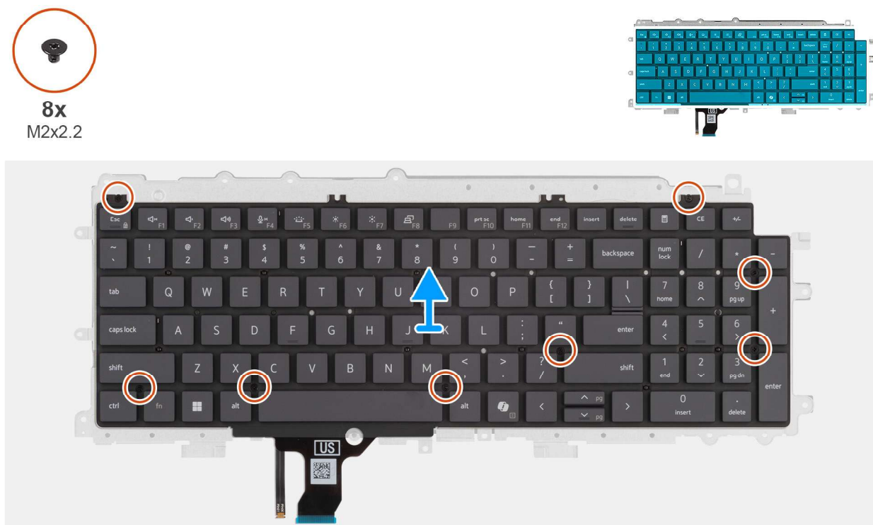
Abbildung 56. Entfernen der Tastaturstützplatte
