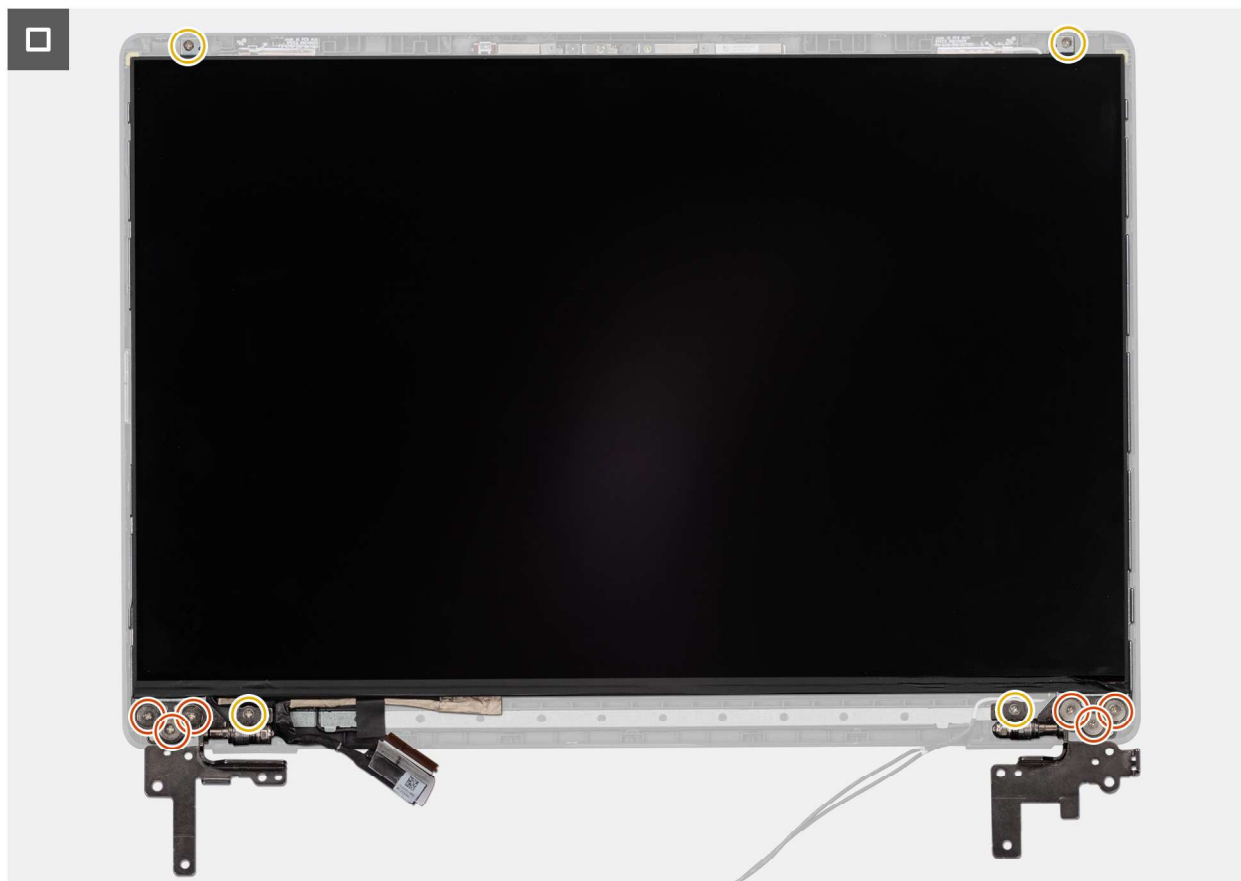
Abbildung 81. Installieren der Bildschirmbaugruppe
