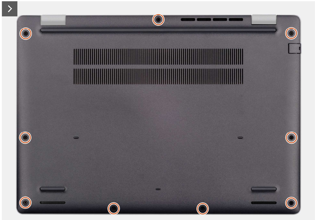
Abbildung 11. Entfernen der Bodenabdeckung
