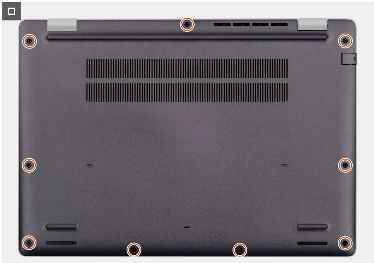
Abbildung 16. Anbringen der Bodenabdeckung
