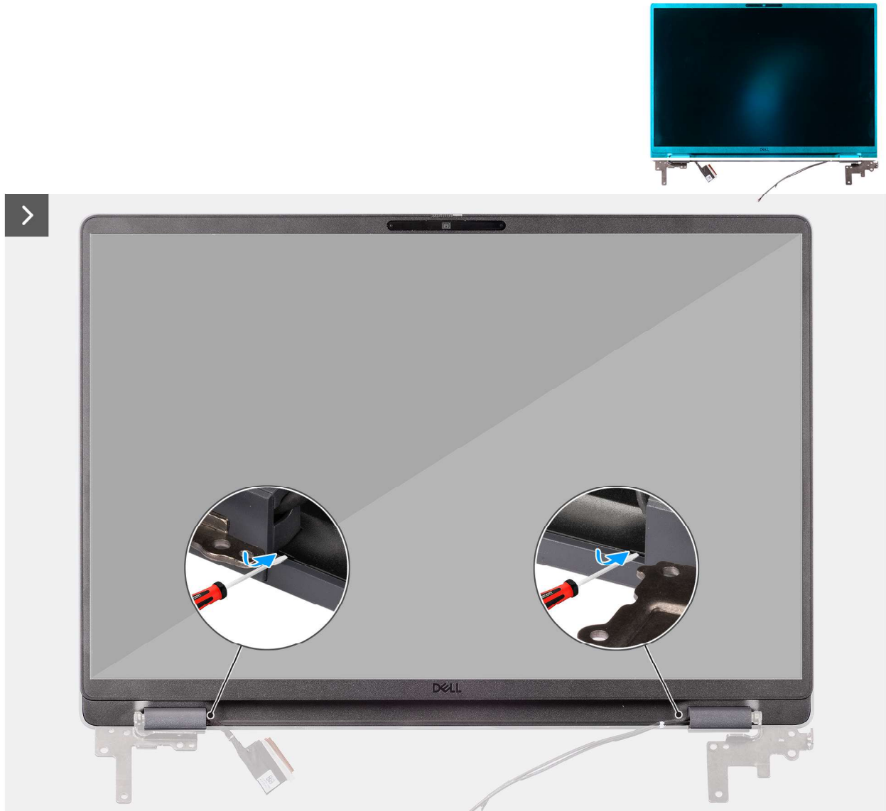
Abbildung 98. Entfernen der Bildschirmblende
