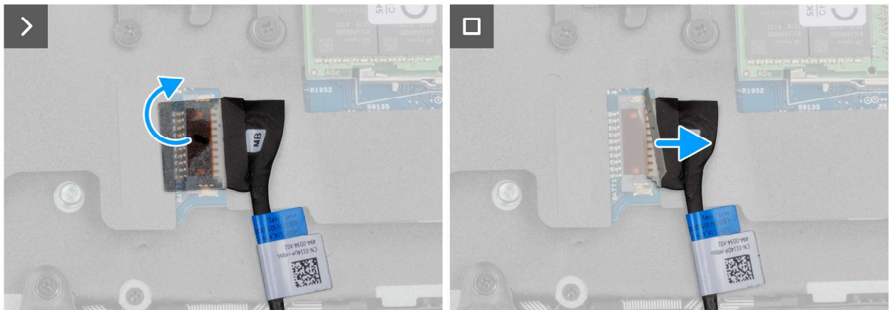
Abbildung 13. Trennen des Akkukabels
