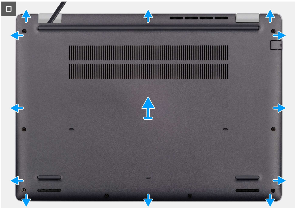
Abbildung 12. Entfernen der Bodenabdeckung
