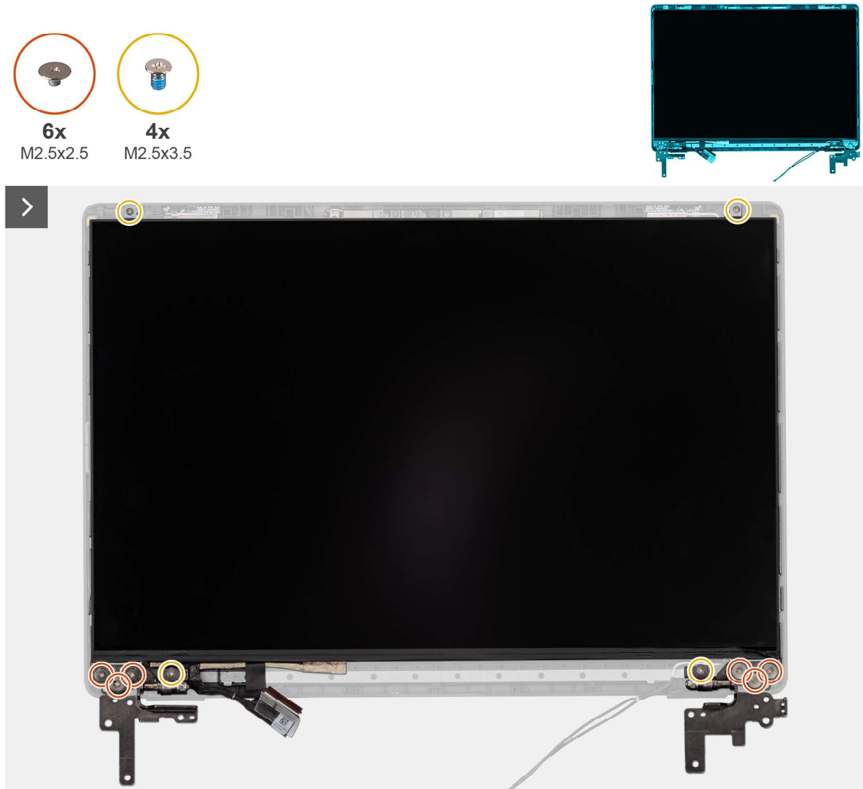
Abbildung 105. Entfernen der Bildschirmbaugruppe
