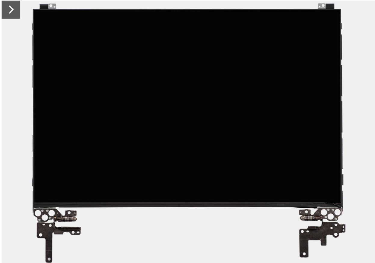
Abbildung 109. Installieren der Bildschirmbaugruppe
