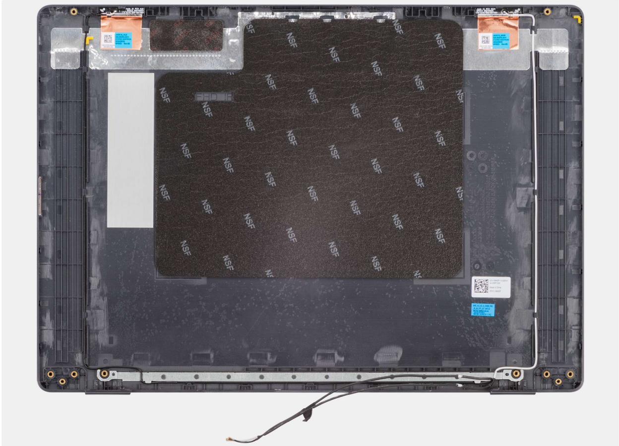
Abbildung 117. Entfernen der Baugruppe der hinteren Bildschirmabdeckung
