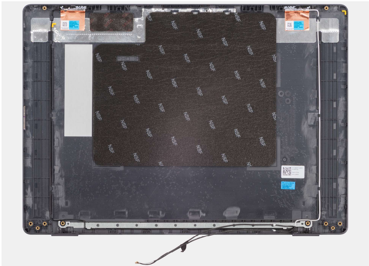
Abbildung 118. Einbauen der Baugruppe der hinteren Bildschirmabdeckung
