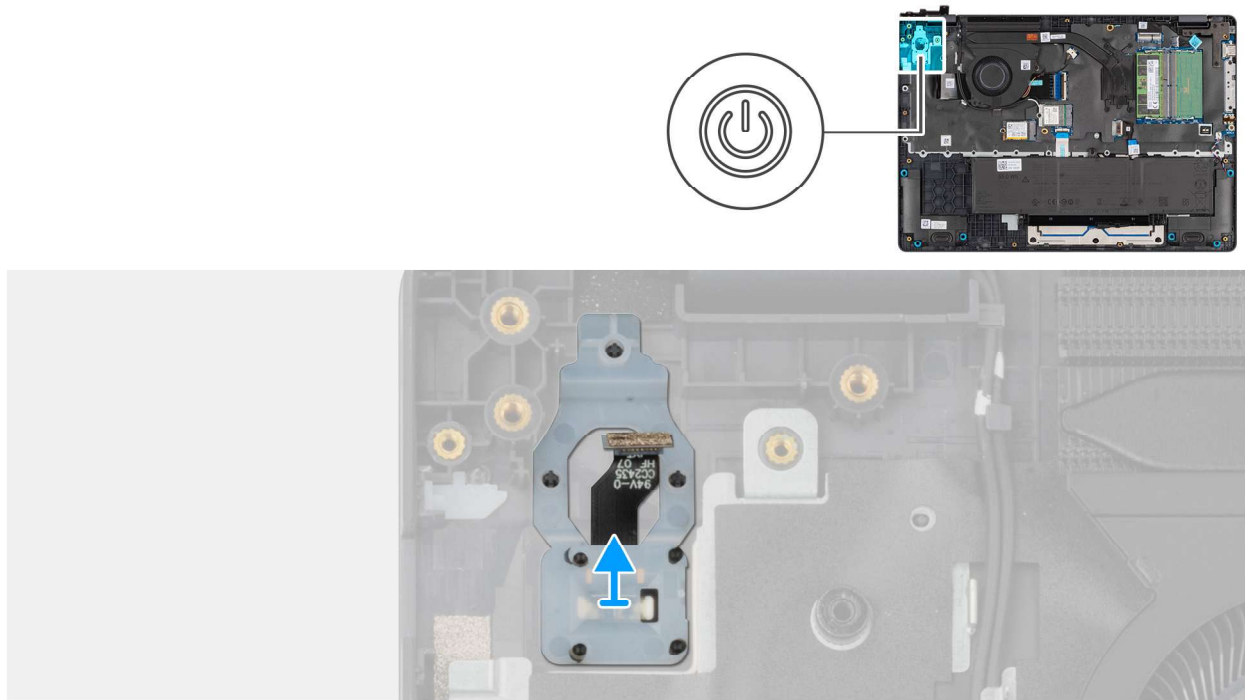
Abbildung 55. Entfernen des Netzschalters mit Fingerabdruck-Lesegerät
