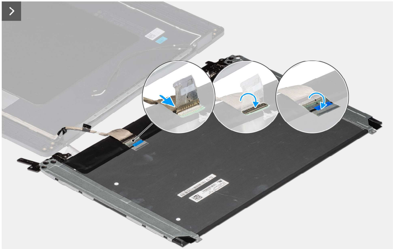
Abbildung 110. Installieren der Bildschirmbaugruppe
