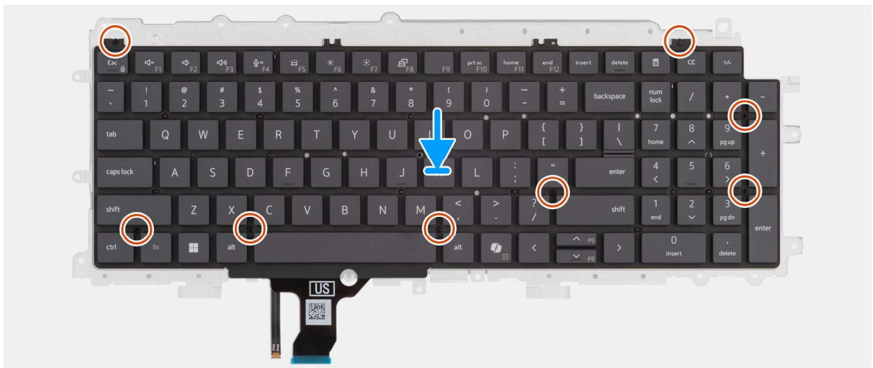
Abbildung 88. Einbauen der Tastaturauflage
