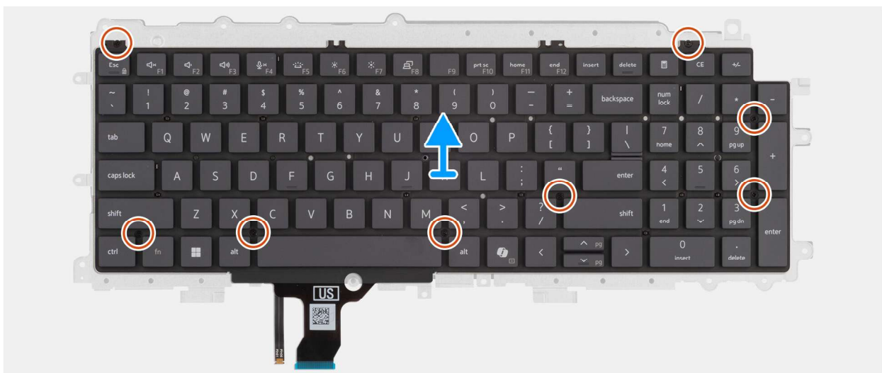
Abbildung 85. Entfernen der Tastaturauflage
