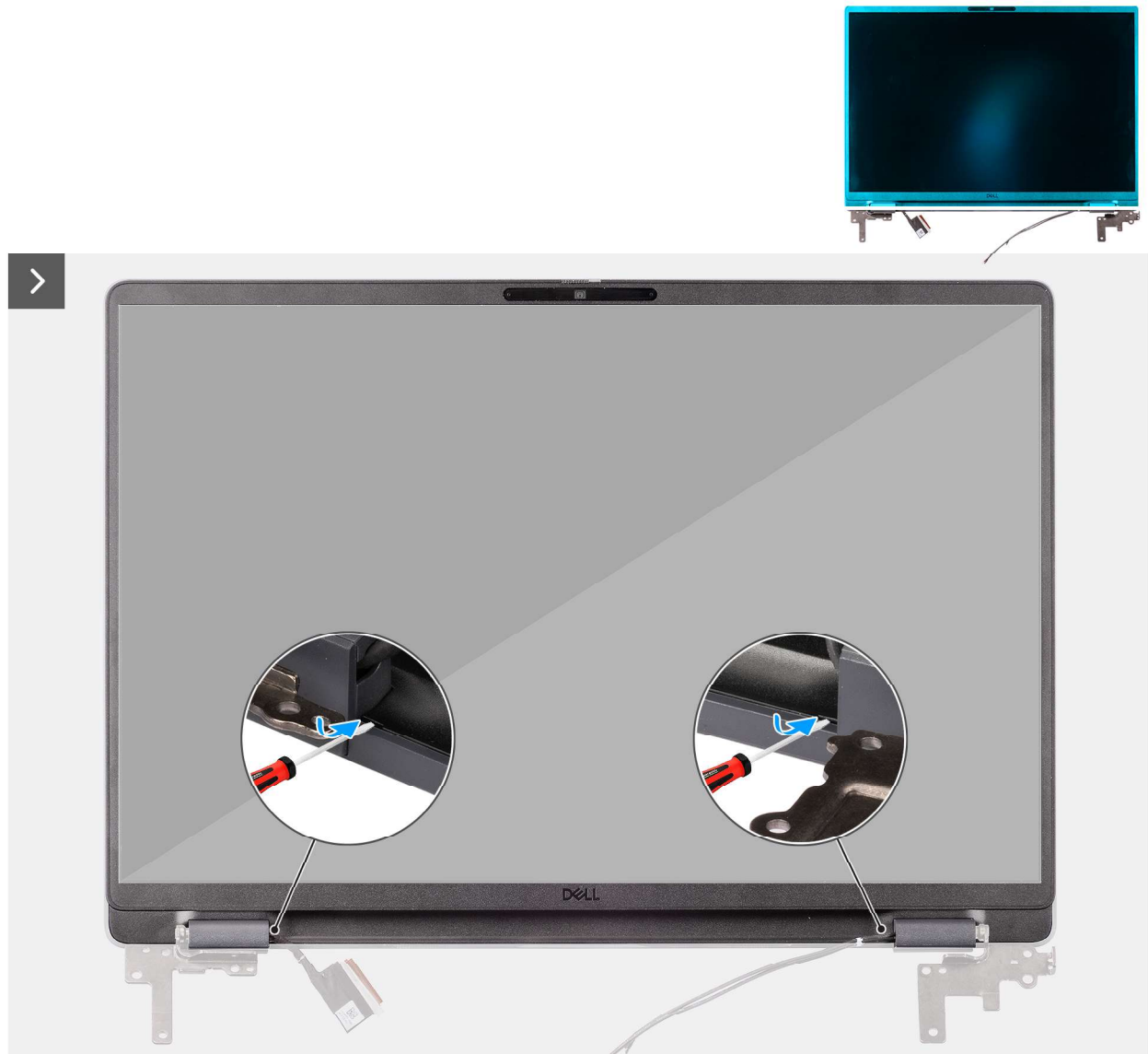
Abbildung 98. Entfernen der Bildschirmblende
