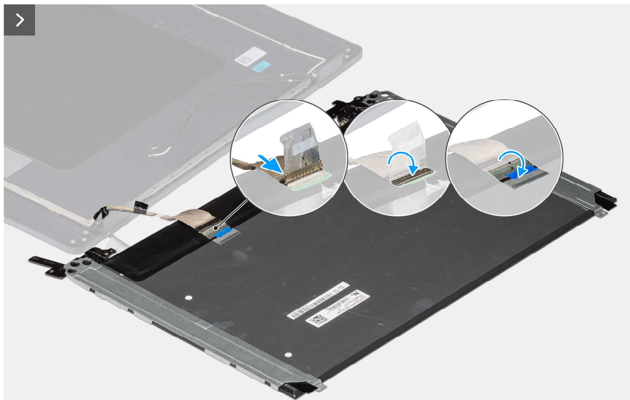
Abbildung 110. Installieren der Bildschirmbaugruppe
