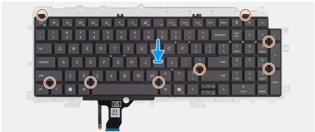
Abbildung 88. Einbauen der Tastaturauflege
