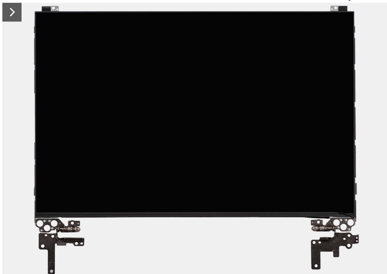
Abbildung 109. Installieren der Bildschirmbaugruppe
