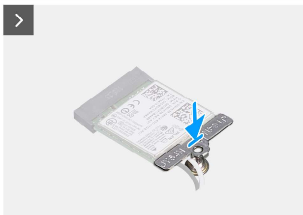
Abbildung 26. Installieren der Wireless-Karte
