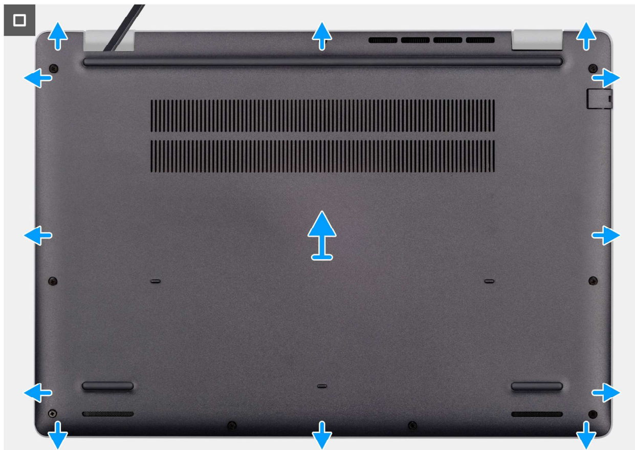
Abbildung 12. Entfernen der Bodenabdeckung
