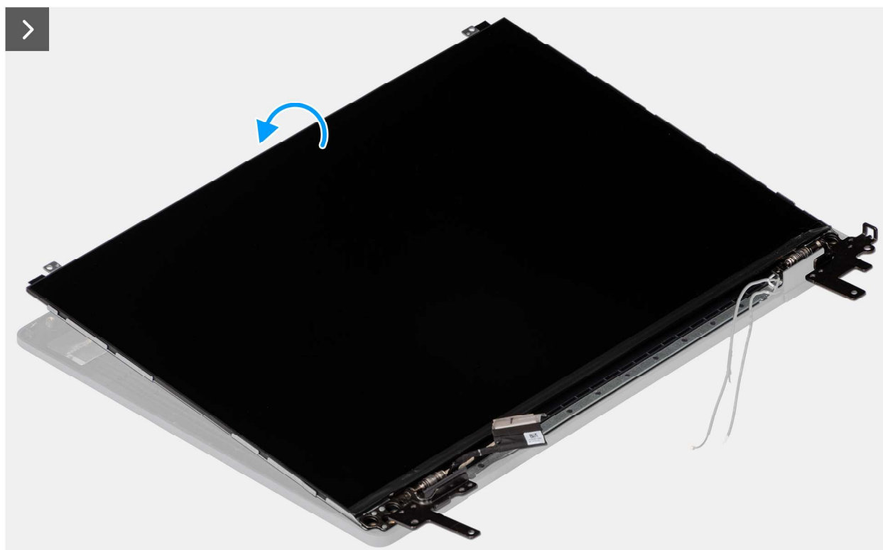
Abbildung 111. Installieren der Bildschirmbaugruppe
