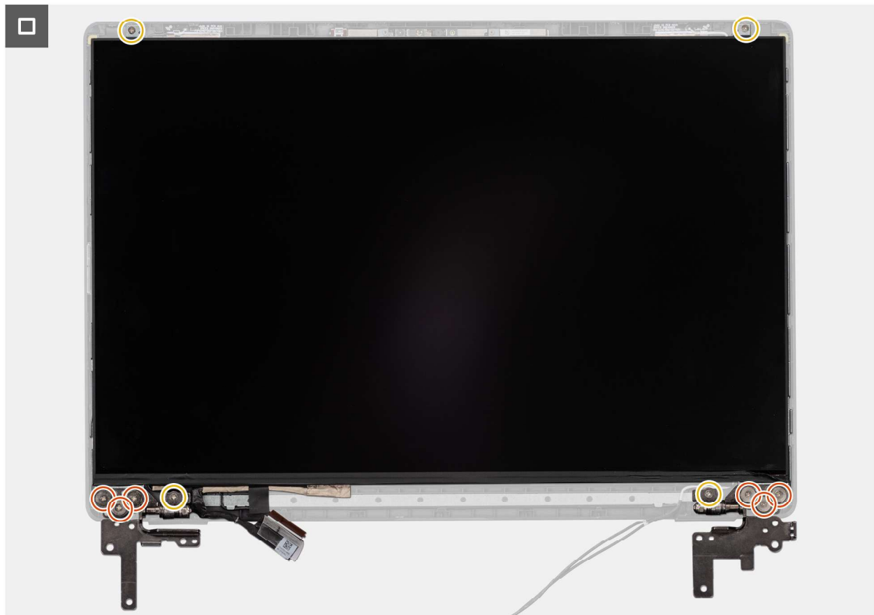
Abbildung 112. Installieren der Bildschirmbaugruppe
