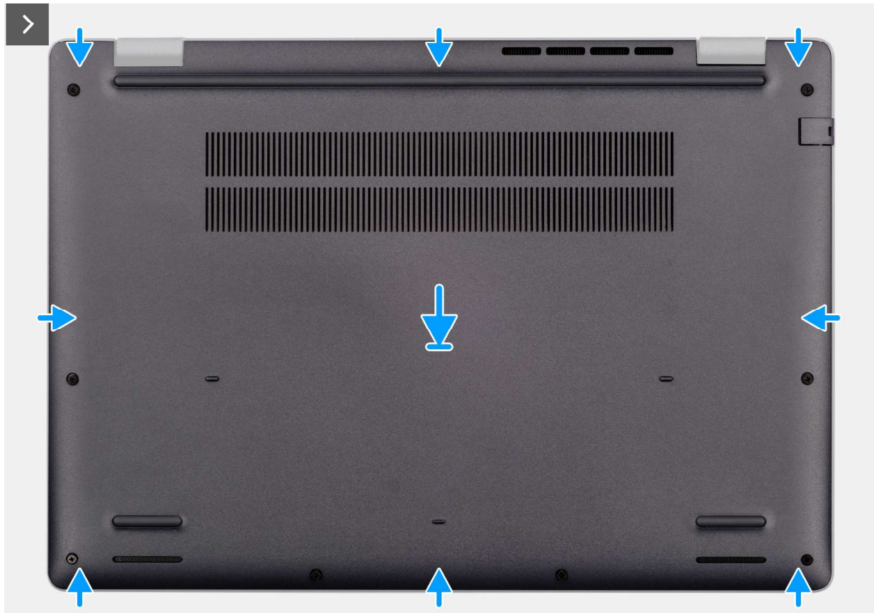
Abbildung 15. Anbringen der Bodenabdeckung
