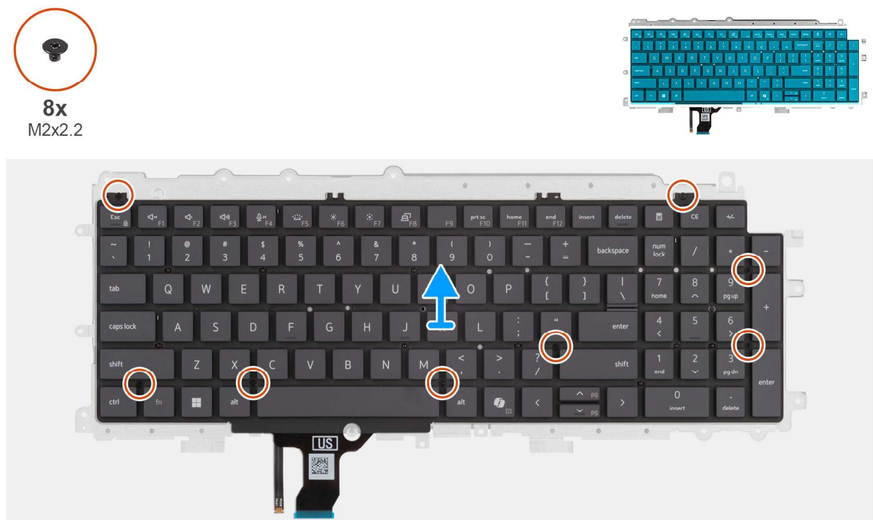
Abbildung 85. Entfernen der Tastaturauflage
