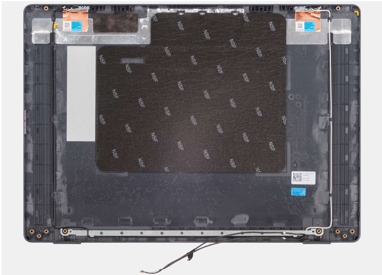
Abbildung 117. Entfernen der Baugruppe der hinteren Bildschirmabdeckung
