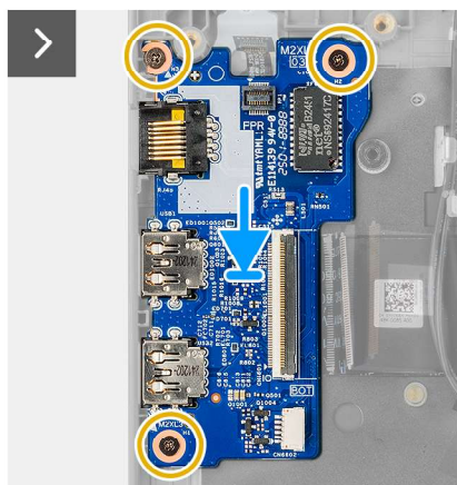
Abbildung 52. Installieren der I/O-Platine
