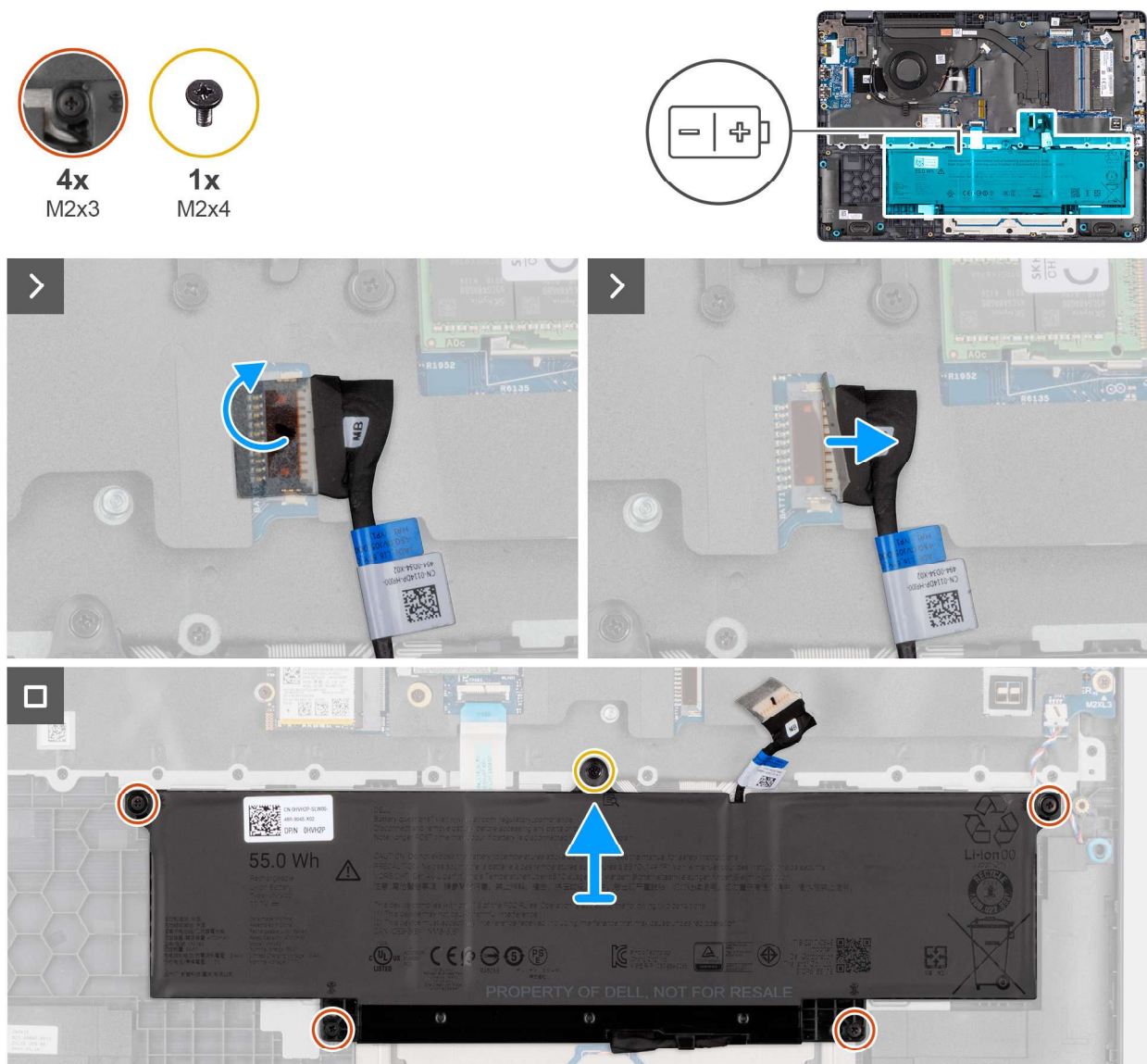
Abbildung 17. Entfernen des Akkus
