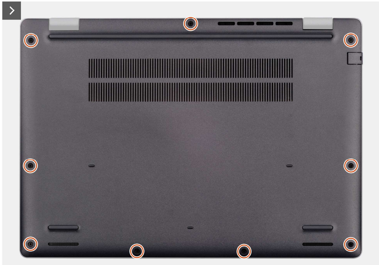
Abbildung 11. Entfernen der Bodenabdeckung
