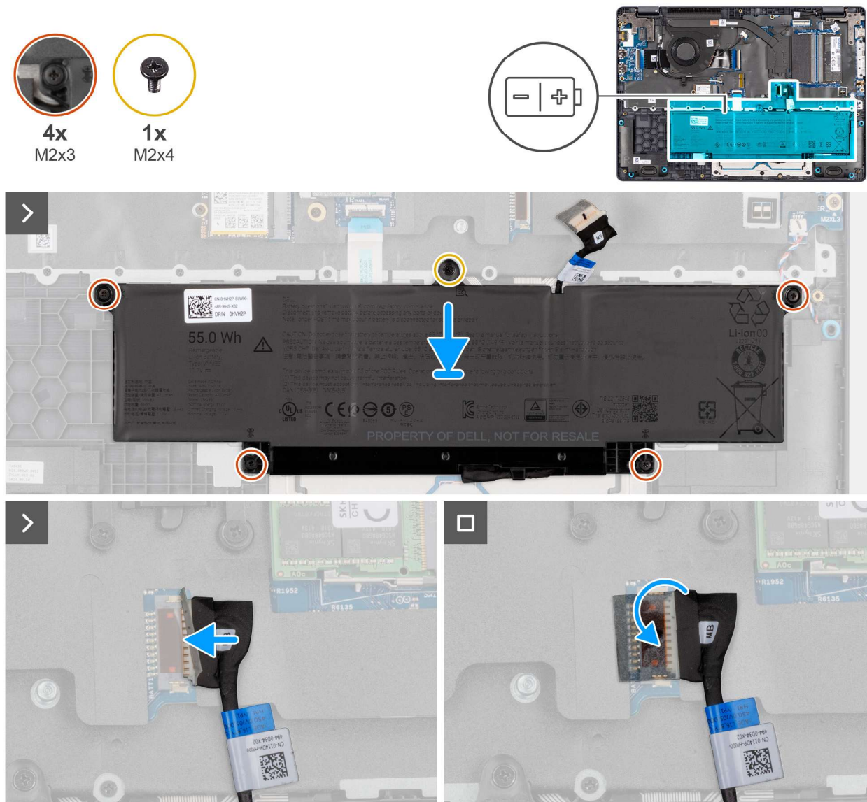
Abbildung 18. Einsetzen des Akkus
