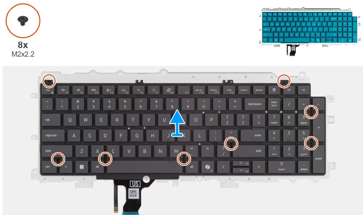
Abbildung 56. Entfernen der Tastaturstützplatte
