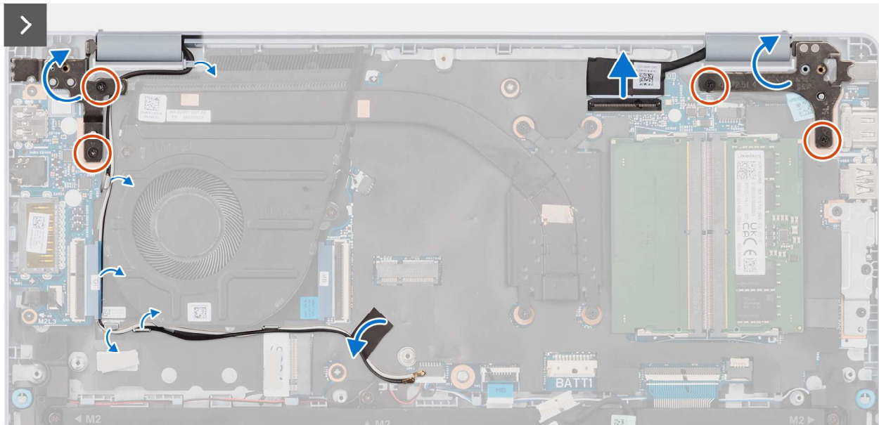
Abbildung 51. Entfernen der Bildschirmbaugruppe
