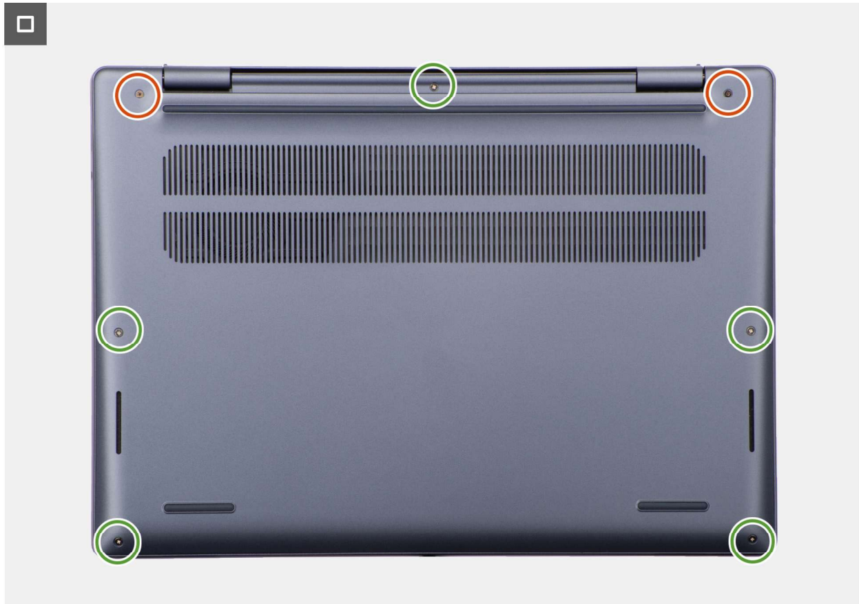
Abbildung 14. Anbringen der Bodenabdeckung
