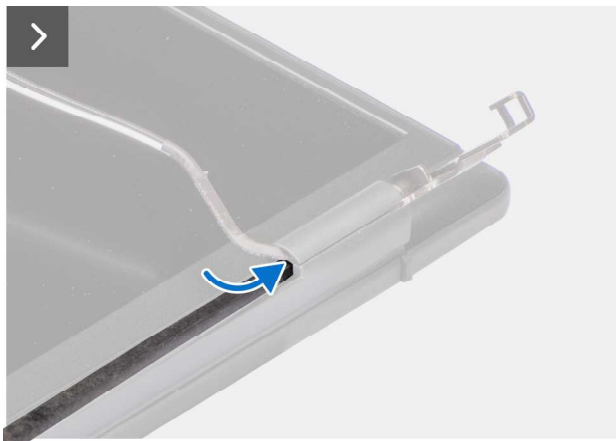
Abbildung 74. Entfernen der Bildschirmblende
