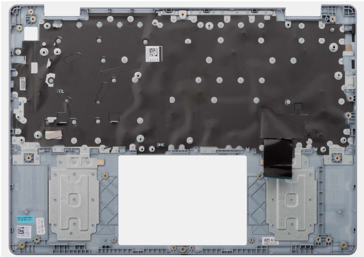
Abbildung 109. Entfernen der Handballenstützen- und Tastaturbaugruppe
