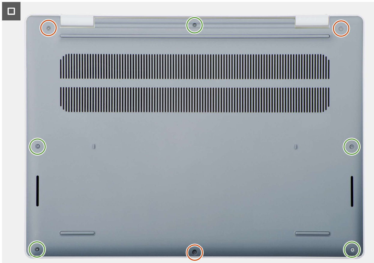
Abbildung 15. Anbringen der Bodenabdeckung
