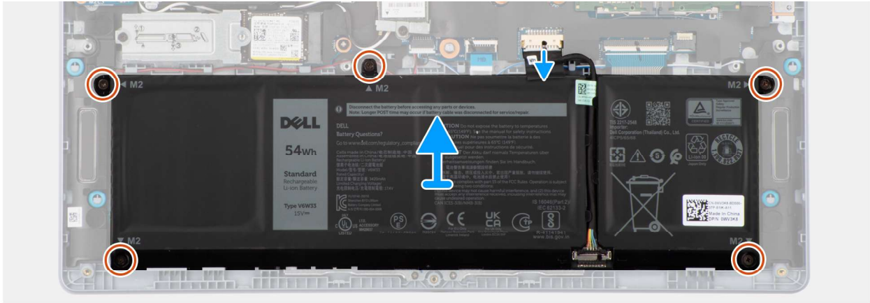
Abbildung 22. Entfernen des Akkus
