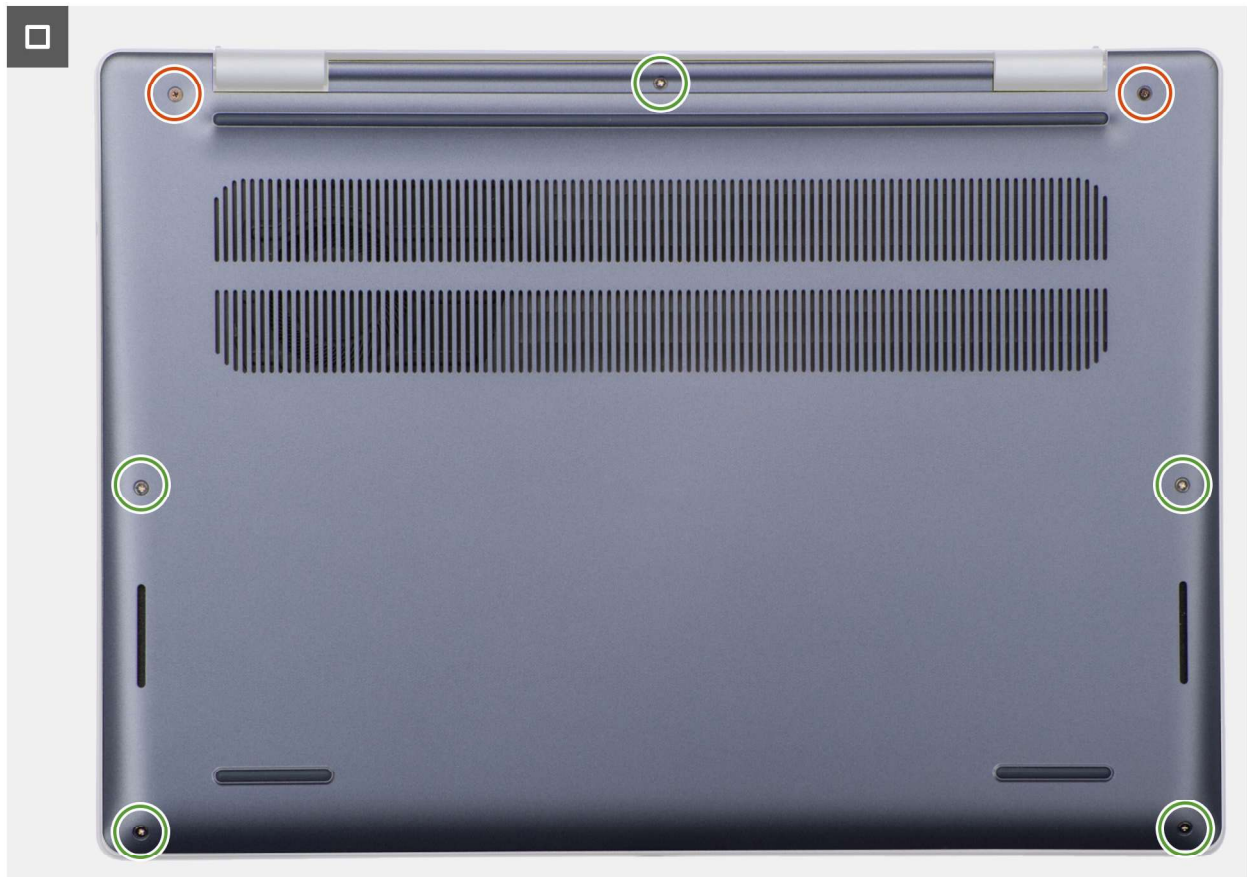
Abbildung 19. Anbringen der Bodenabdeckung
