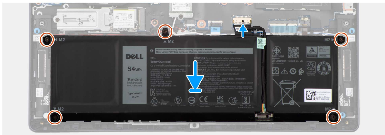
Abbildung 25. Einsetzen des Akkus
