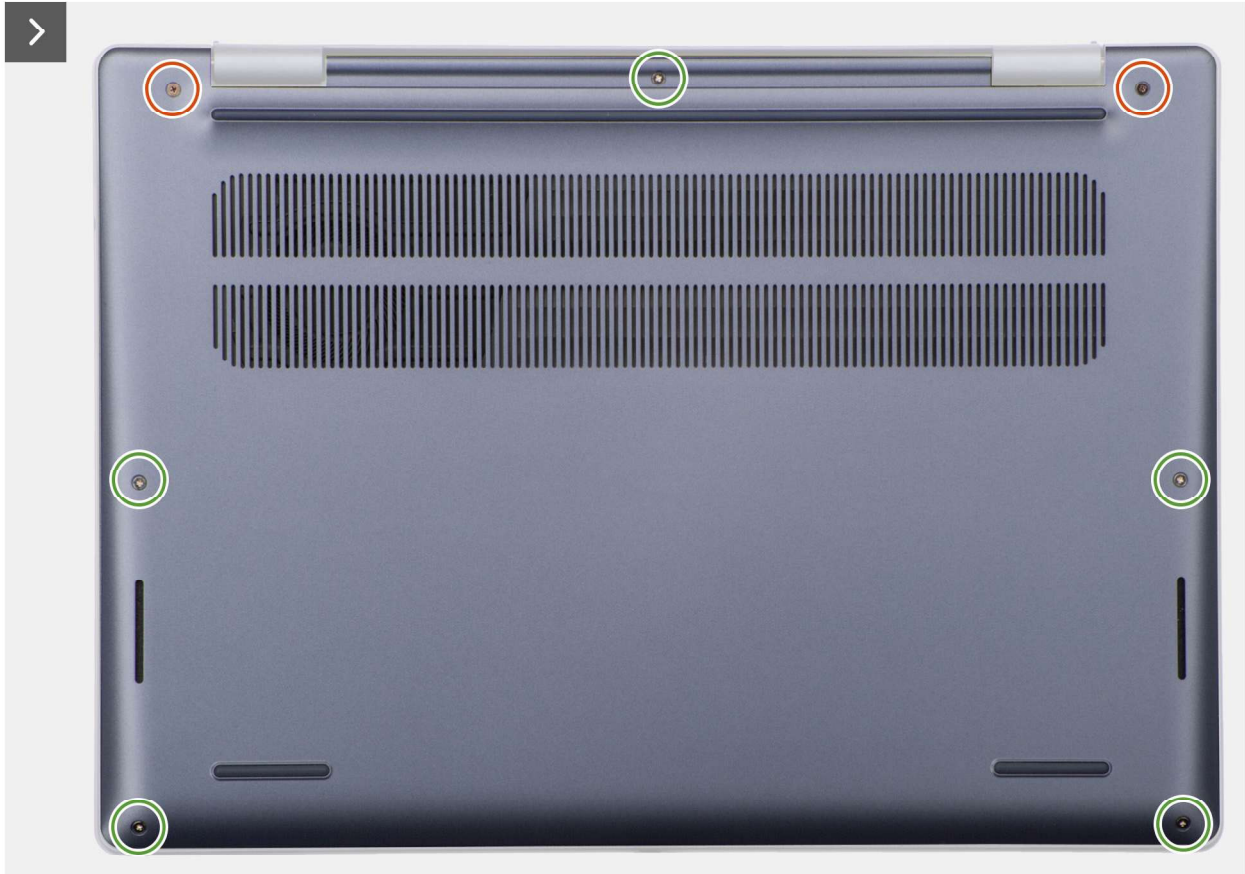
Abbildung 16. Entfernen der Bodenabdeckung
