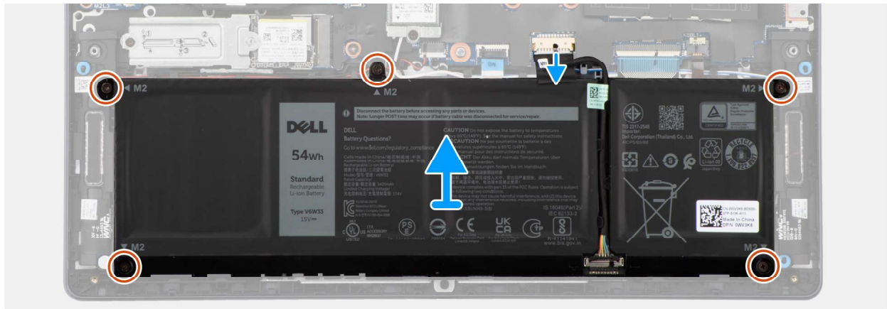
Abbildung 24. Entfernen des Akkus
