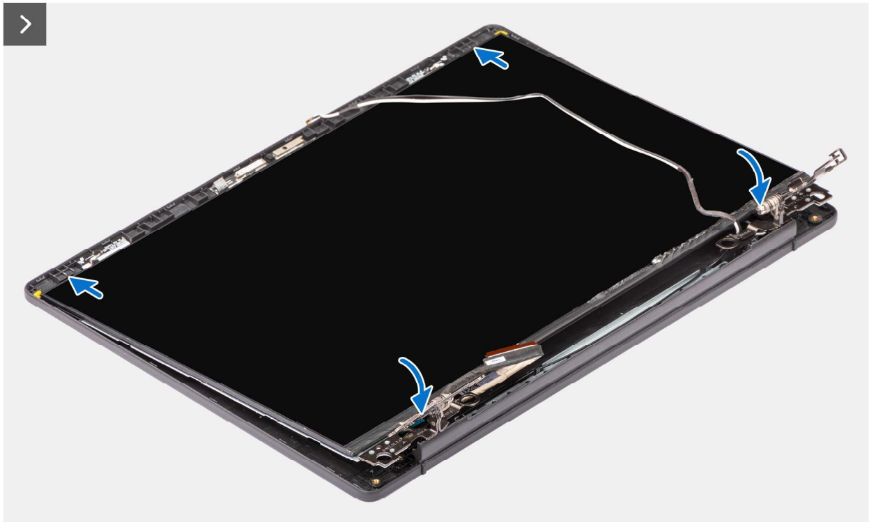
Abbildung 82. Anbringen der Schrauben
