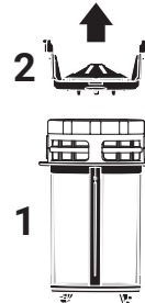
Darstellung 7.3.3: Entfernen des Grobfilters
