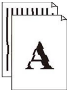
Las líneas no están alineadas/ están distorsionadas
