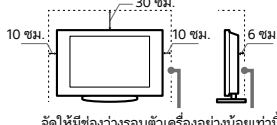
จัดให้มีช่องว่างรอบตัวเครื่องอย่างน้อยเท่านี้
