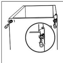
6. Odkręć i usuń bolec dolnego zawiasu, obróć konsolę i zamontuj ją z powrotem. a vratte ji zpět.
