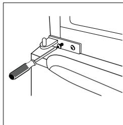
10. Csavarozza le a felfüggesztés csapját és fordítsa el a felfüggesztést. Ezután a felfüggesztés csapját helyezze ismét vissza.
