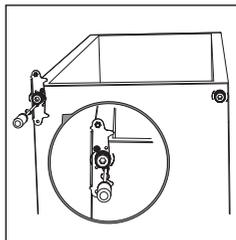
8. Vyjměte dveřní těsnění z dveří chladničky i mrazničky a poté je (po otočení o 180°) vraťte na původní místo.
