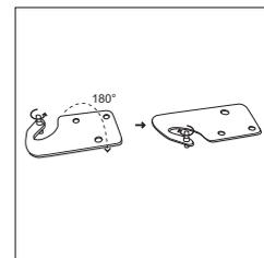
11. Nasadíte horné dvere späť. Než definitívne zaskrutkujete horný záves, skontrolujte, či dvere horizontálne aj vertikálne doliehajú a či tesnenie po všetkých stranách správne dosadá. Potom priložte záves a zaskrutkujte ho do hornej časti spotrebiča.
