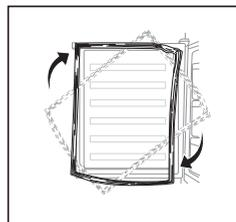
9. Otočte střední závěs o 180°, poté jej přesuňte na levou stranu. Nasadte spodní dveře zpět. Zasuňte kolík středního závěsu do horního otvoru spodních dveří a dotáhněte šrouby.
