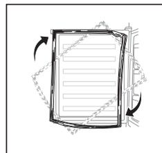
9. Obróć środkowy zawias o 180°, a następnie przesuń go na lewą stronę. Zamontuj dolne drzwi z powrotem. Włóż bolec środkowego zawiasu do górnego otworu dolnych drzwi i dokręć śruby.
