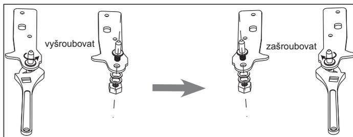
7. Nasadte konzoli na kolík spodního závěs. Vraťte zpět obě nastavitelné nožky. Spodní dveře přesuňte na požadovanou pozici.
