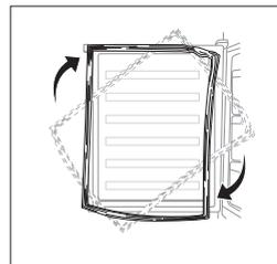
9. Otočte stredný záves o 180°, potom ho presuňte na ľavú stranu. Nasadíte spodné dvere späť. Zasuňte kolík stredného závesu do horného otvoru spodných dverí a dotiahnite skrutky.
