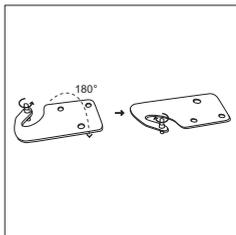
11. Nasadte horní dveře zpět. Než definitivně zašroubujete horní závěs, zkontrolujte, zda dveře horizontálně i vertikálně lícuji a zda těsnění po všech stranách správně dosedá. Poté přiložte závěs a zašroubujte jej do horní části spotřebiče.
