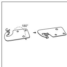
11. Załóż górne drzwi z powrotem. Zanim ostatecznie przykręcisz górny zawias, sprawdź, czy drzwi są wyrównane zarówno poziomo, jak i pionowo, oraz czy uszczelka dobrze przylega z każdej strony. Następnie zamontuj zawias i przykręć go do górnej części urządzenia.
