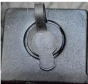
2. Ladestecker einstecken – Stecken Sie das Ladegerät in die Ladebuchse des Rollers.
