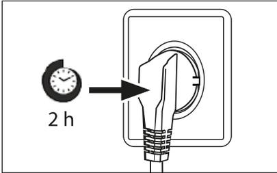
El aceite de lubricación sin mantenimiento se encuentra en la cápsula del compresor. Este aceite puede pasar por el sistema de tuberías cerradas durante el transporte si el electrodoméstico está inclinado. Antes de conectar el electrodoméstico a la fuente de alimentación, espere al menos 2 horas para que el aceite vuelva a entrar en la cápsula.
